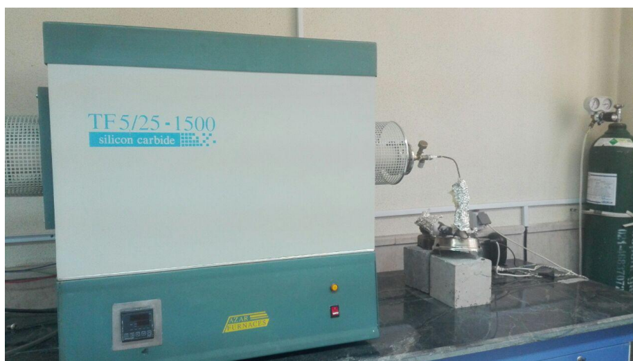
شکل ۳-۴: کوره لوله‌ای همراه با گاز آرگون برای انجام عملیات حرارتی پوشش‌های فلزی
