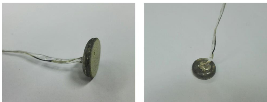
شکل ۳-۱۰: نمونه مانت شده برای آزمون EIS
