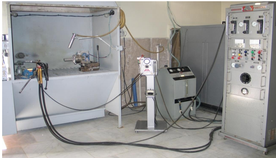
شکل ۳-۸: سیستم پاشش APS به کاررفته در پوشش سرامیکی واقع در پژوهشکده مواد و انرژی
