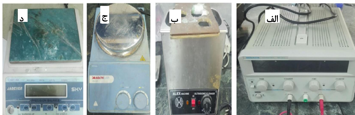
شکل ۳-۵: تجهیزات به کار رفته: الف) منبع تغذیه ب) دستگاه آلتراسونیک ج) همزن مغناطیسی د) ترازو دیجیتال
