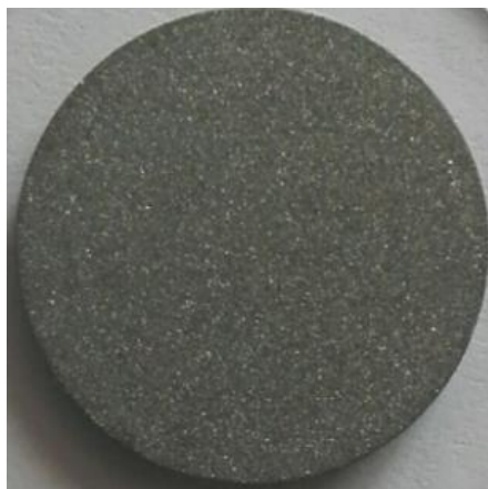
شکل ۳-۱: نمونه سوپر آلیاژ پایه نیکل استفاده شده در این تحقیق
