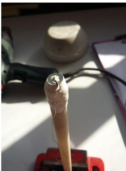
شکل ۲-۲۰: نمونه آب‌بندی شده با چسب سرامیکی دما
