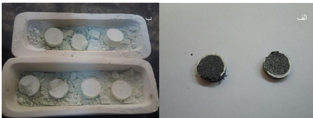
شکل ۱-۳: الف) جدا شدن دولایه بعد پرس ب) فروپاشی لایه متخلخل بعد پیش پخت
