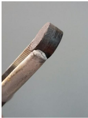
شکل ۲-۳: نفوذ اکسید مس به درون لایه چگال الکترولیت
