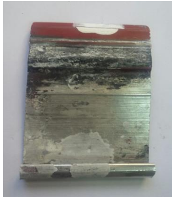
شکل ۳-۶: کاردک مورد استفاده در فرآیند چاپ
