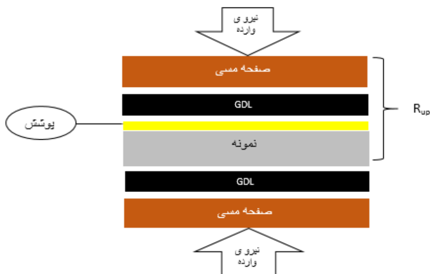
شکل ۲-۷- چیدمان اول مقاومت تماسی برای نمونه‌های باپوشش.
