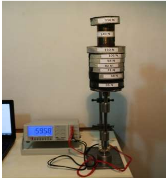
شکل ۲-۴- چیدمان مکانیکی برای اعمال فشار در آزمون مقاومت تماسی.
