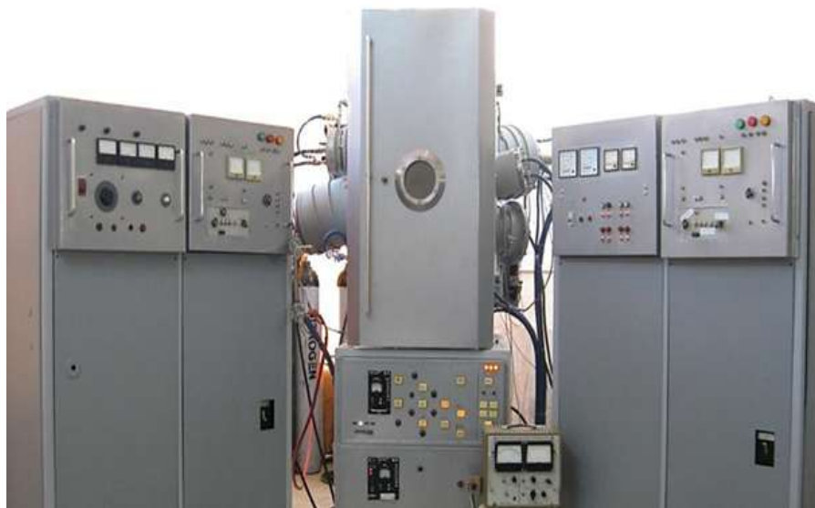
شکل ۲-۲- دستگاه لایه‌نشانی تبخیر قوس کاتدی.
