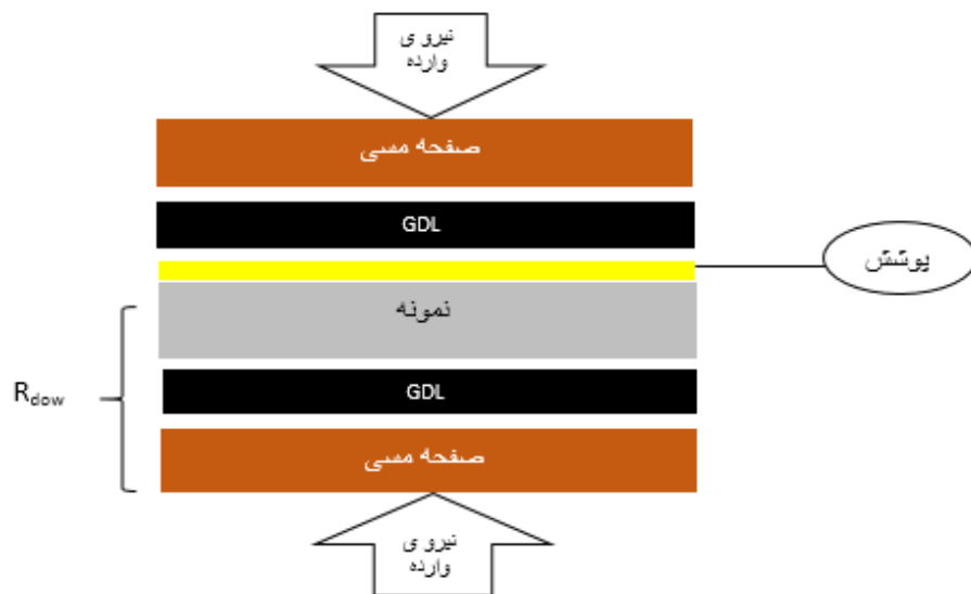
شکل ۸-۲- چیدمان دوم مقاومت تماسی برای نمونه‌های با پوشش.
