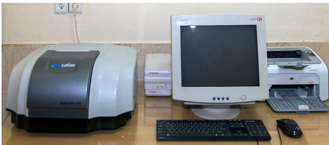
شکل ۳-۵: دستگاه طیف‌سنجی مادون قرمز تبدیل فوریه استفاده شده جهت شناسایی گروه‌های عاملی نانوکامپوزیت‌ها.
