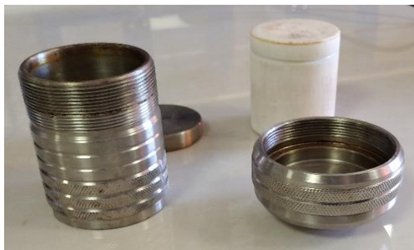
شکل ۳-۱: محفظه استفاده شده جهت سنتز نقاط کوانتومی کربنی از جنس استیل ضد زنگ و با پوشش داخلی تفلن.
