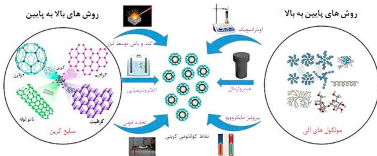
شکل ۲-۳ شماتیک دو روش کلی سنتز نقاط کربنی [۵۸].
