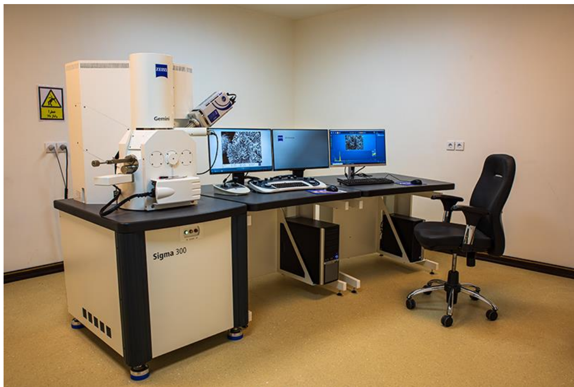
شکل ۳-۷: دستگاه میکروسکوپ الکترونی روبشی نشر میدانی مورد استفاده.
