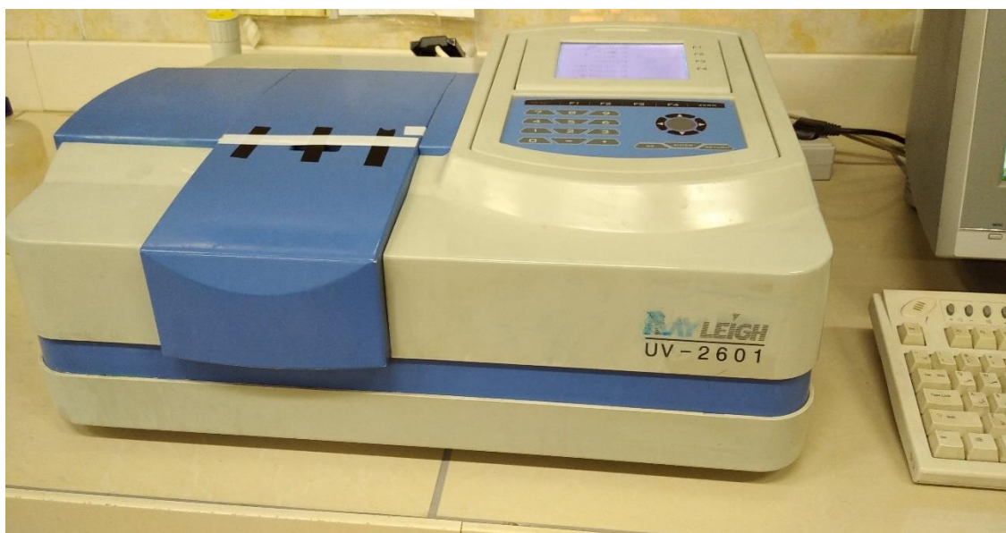
شکل ۳-۴: دستگاه طیف‌سنجی فرابنفش-مرئی استفاده شده جهت بررسی طیف‌جذبی نانوکامپوزیت‌های سنتز شده.
