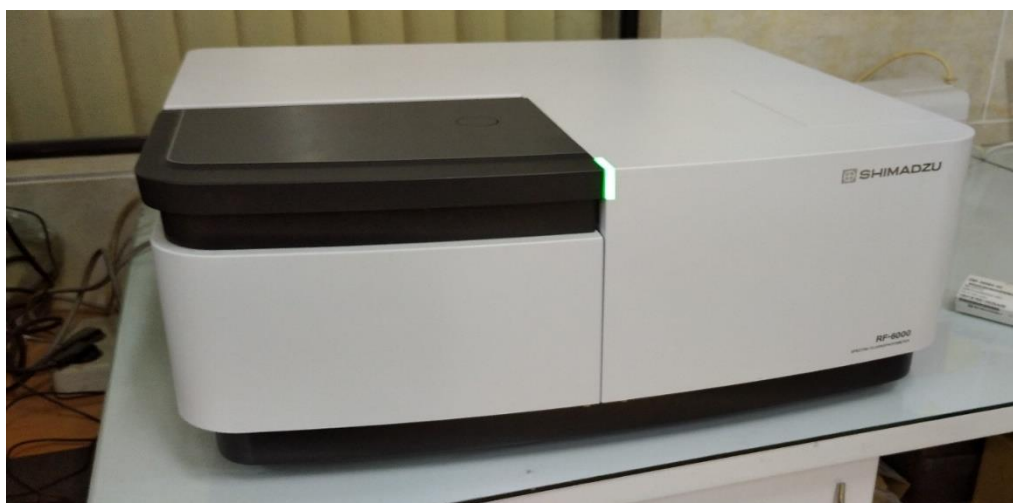
شکل ۳-۶: دستگاه طیف‌سنجی فلورسانس استفاده شده جهت بررسی خواص لومینسانس نانوکامپوزیت‌های سنتز شده.
