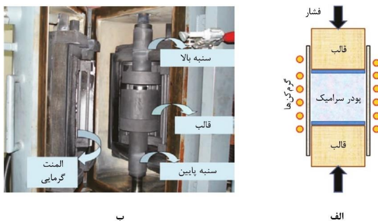
شکل ۲-۵. شماتیکی از فرآیند پرس گرم [۹].
