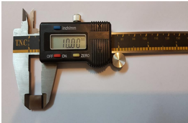
شکل ۳-۱- ابعاد نمونه برش زده شده توسط وایرکات
