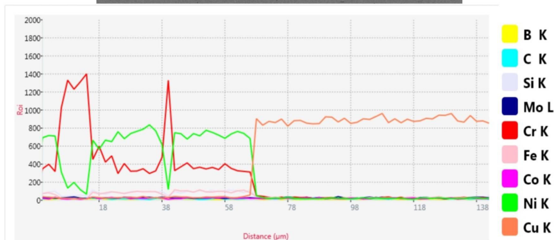
شکل ۴-۶: آنالیز عنصری خطی از سطح مقطع نمونه N20C.
