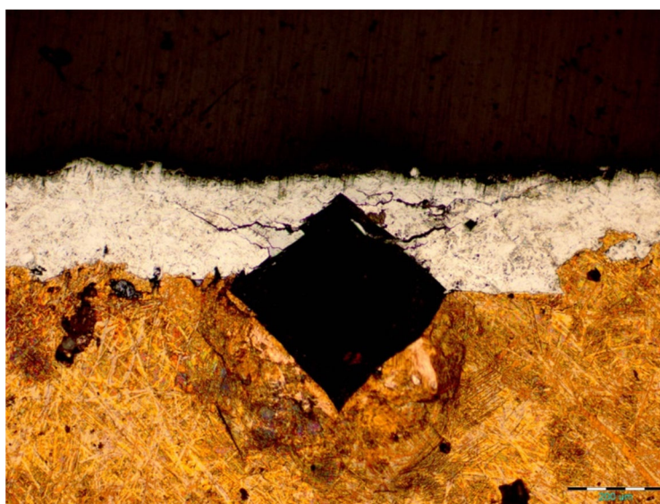
شکل ۴-۱۹: تصویر میکروسکوپ نوری از سطح مقطع نمونه N20C پس از آزمون چسبندگی.
