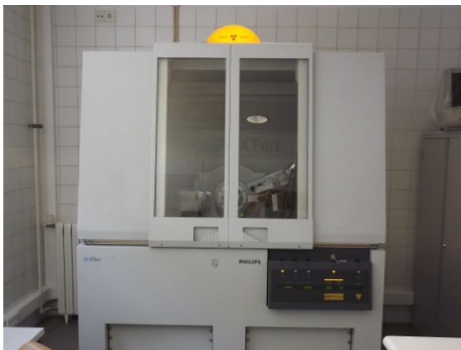
شکل (۳-۳) دستگاه XRD philips PW1730
