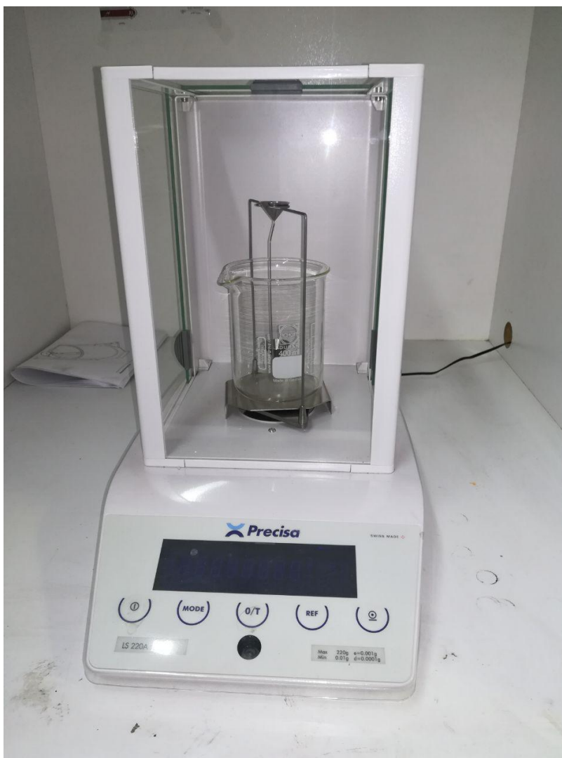
شکل ( ۳-۶ ) ترازوی دیجیتال به همراه کیت مکمل جهت اندازه گیری چگالی بصورت مستقیم
