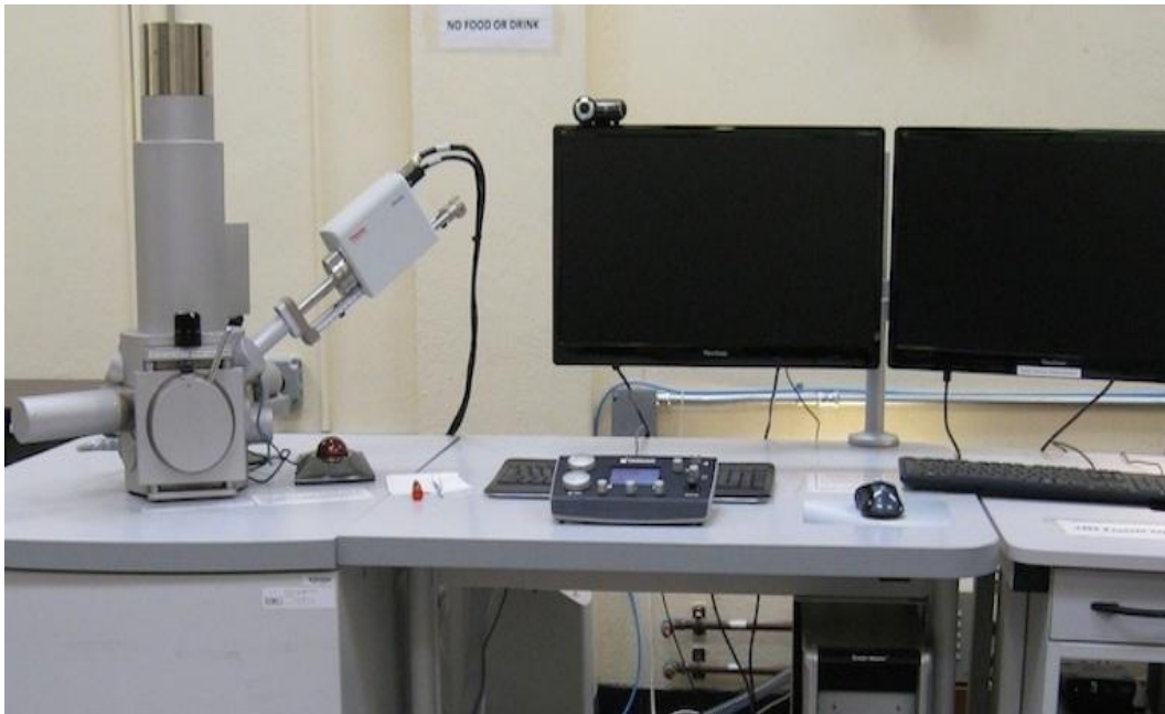
شکل (۳-۴) دستگاه VEGA// TESCAN SEM
