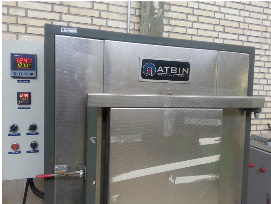
شکل (۲-۳) کوره ATBIN ذوب شیشه
