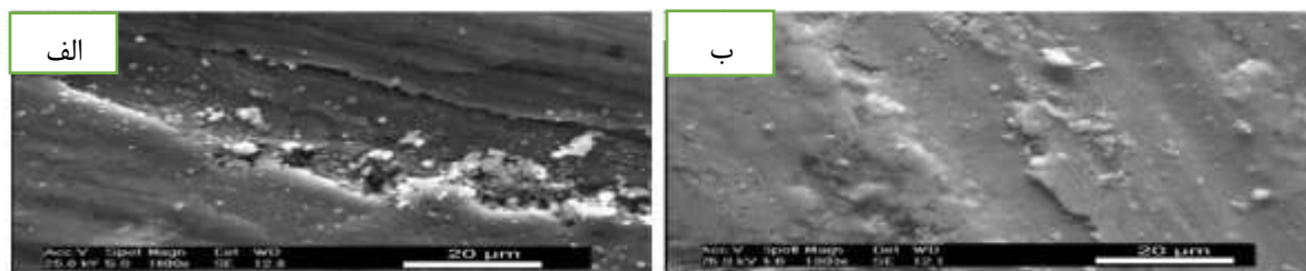
شکل ۴۶-۲ تصویر SEM از سطح سایش Al_6O_6 / SiC [۴۲].
