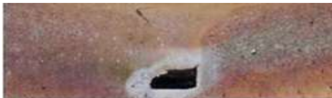
شکل ۲-۴۸ عیب تونلی AMC با ۸۵ min/mm و ۱۲۰۰ rpm [۴۴].
