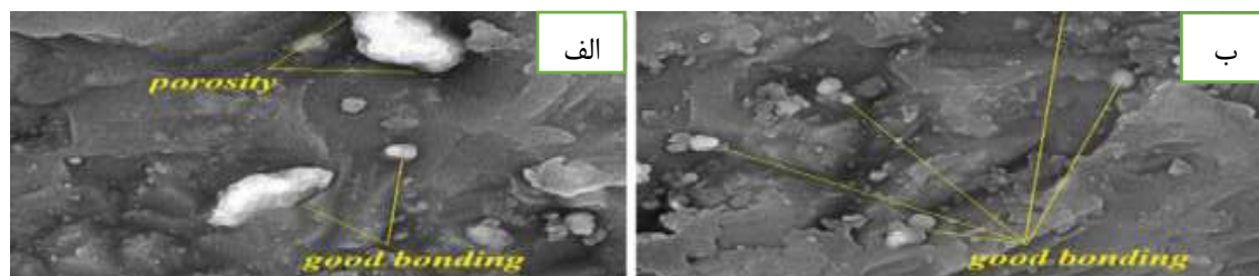
شکل ۲-۳۳ تصویر SEM ذرات الف) ۸۰۰ rpm / ۸۰ mm\min (ب) ۱۲۵۰ rpm / ۸۰ mm\min [۲۹].
