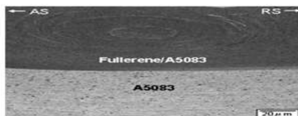
شکل ۲-۷ میکروسکوپ نوری از سطح مقطع نمونه FSP شده ۵۰۸۳ Al با فلورن [۹].
