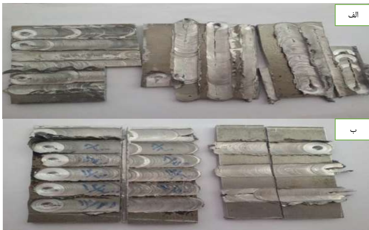
شکل ۱-۴ (الف) نمونه‌های آزمایشی شیاردار با سرعت پیشروی ۲۰ میلیمتر بر دقیقه (ب) نمونه‌ها با سرعت پیشروی ۸ و ۱۲ میلیمتر بر دقیقه
