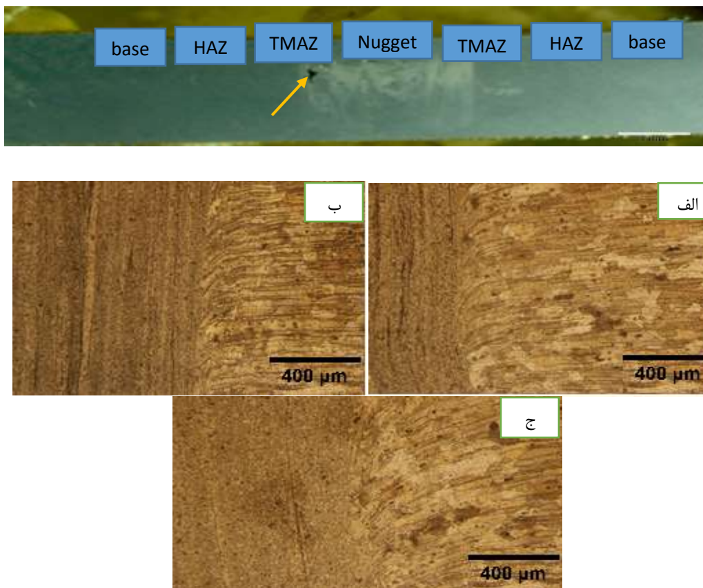
شکل ۳-۴ (الف) تصویر میکروسکوپ نوری نمونه A ۱ با ۵ درصد وزنی (ب) نمونه A ۲ با ۱۰ درصد وزنی (ج) نمونه A ۳ با ۱۵ درصد وزنی ذرات تقویت‌کننده.
