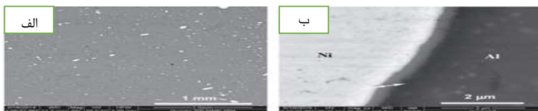
شکل ۲-۵۵ (الف) توزیع ذرات (ب) سطح ذرات زمینه Al 50.83 / Ni با بال میل [۵۰].
