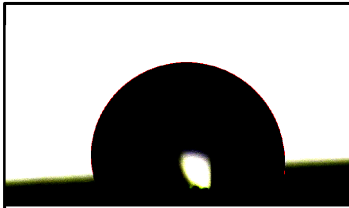
شکل ۴-۱۰: تصویر میکروسکوپی تست تر شوندگی روی داربست پلی وینیل الکل
