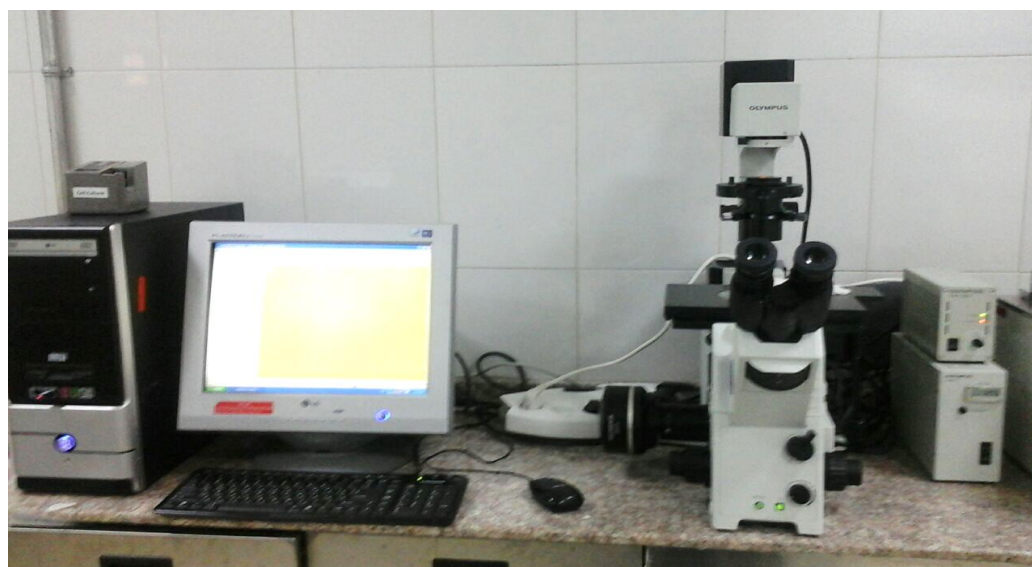
شکل ۳-۷: میکروسکوپ نوری مجهز به فلورسانس
