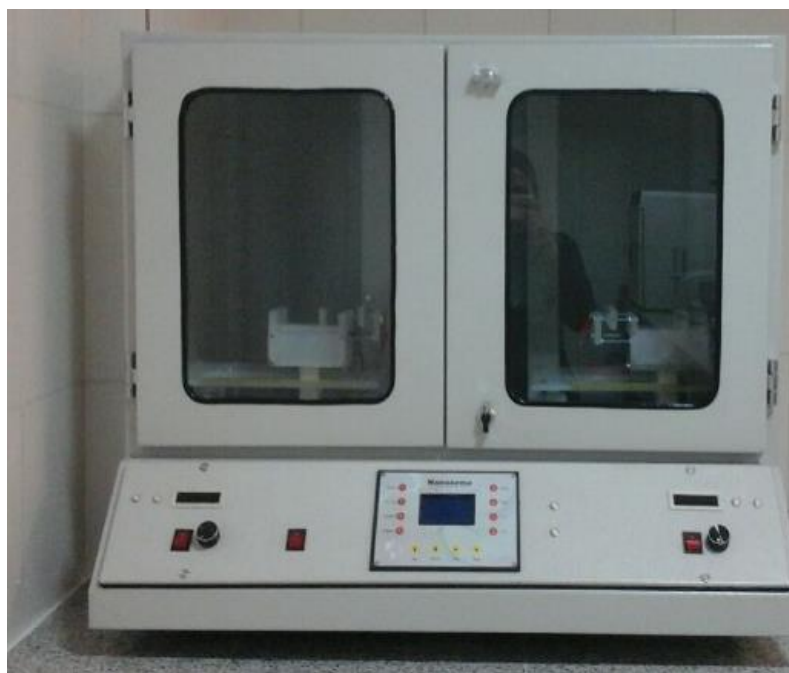
شکل ۳-۳: دستگاه الکتروریسی برای ساخت داربست پلی وینیل الکل
