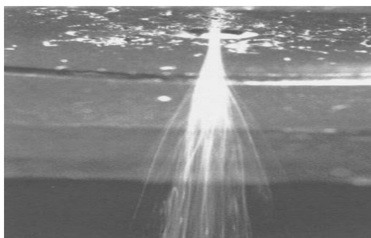
شکل ۲-۳۵: خروج الیاف PET از نخ‌ریس [۳۶]
