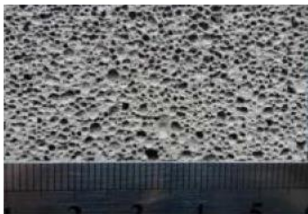
شکل ۲-۲۲: سطح شکست نمونه‌ی ژئوپلیمر [۳۴]
