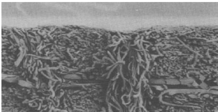
شکل ۲-۲۹: سطح مقطع یک شبکه سوراخ شده با سوزن با بزرگنمایی ۶۲ [۳۶]
