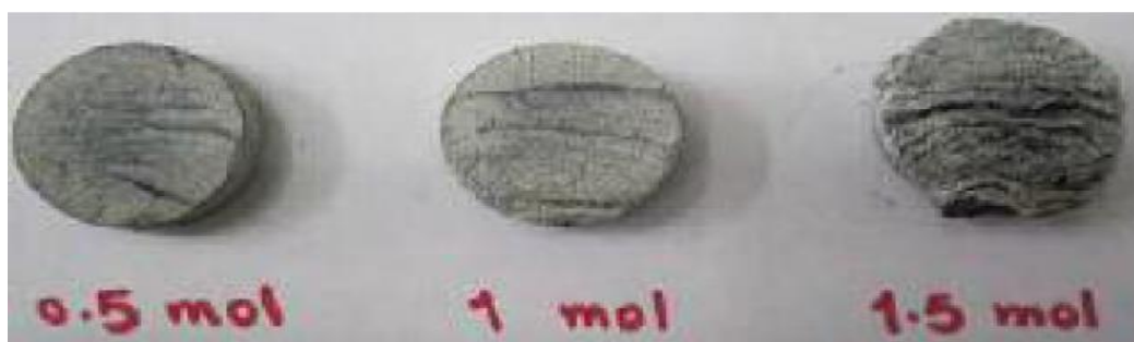
شکل ۲-۱۶: افزایش تخلخل ماکروسکوپی بر روی سطح نمونه‌ها با افزایش میزان ماده گاززا [۲۸]
