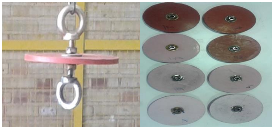
شکل ۳-۱۲- نصب یراق آلات روی چترک.
