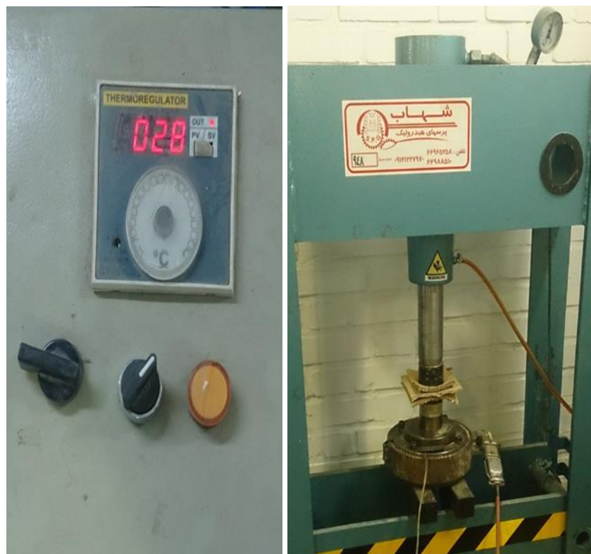
شکل ۳-۱۰- قرار دادن قالب تحت پرس گرم.
