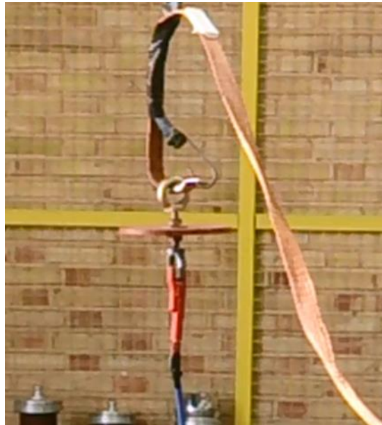
شکل ۳-۱۹- نمونه تحت آزمون ولتاژ فرکانس قدرت در حالت خشک.
