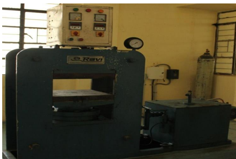
شکل ۲-۱۱- تصویر دستگاه پرس هیدرولیکی گرم [۲۴].
