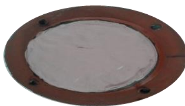
شکل ۳-۹- نحوه قرار گرفتن مواد درون قالب.
