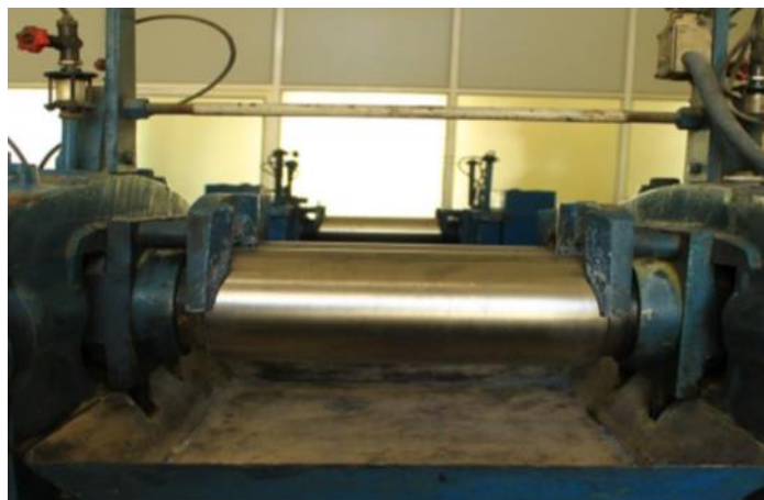
شکل ۲-۱۰- تصویر دستگاه مخلوط‌کن دو میل [۲۴].
