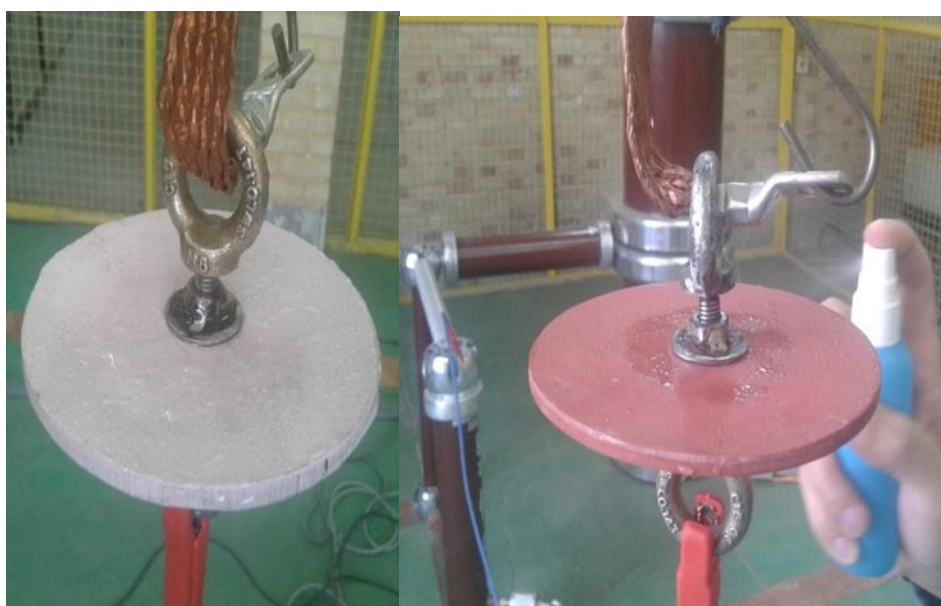
شکل ۳-۲۰- نمونه تحت آزمون ولتاژ فرکانس قدرت در حالت خیس.
