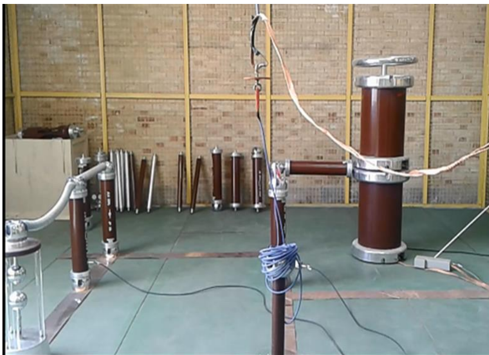
شکل ۳-۱۸- نحوه قرار گرفتن نمونه در آزمون حداکثر ولتاژ پایداری فرکانس قدرت.
