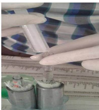
شکل ۳-۱۵- مرحله تزریق کردن رزین.
