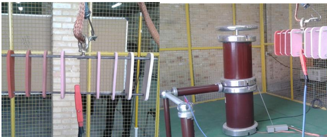
شکل ۳-۲۵- نحوه قرار گرفتن نمونه در آزمون فرسایش.
