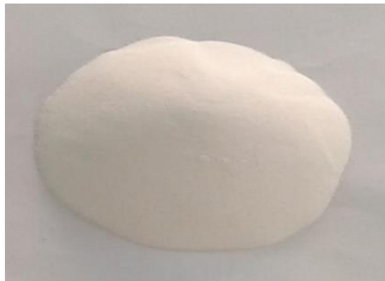
شکل ۳-۲- تصویری از ذرات تقویت‌کننده تری‌هیدرات آلومینیوم.
