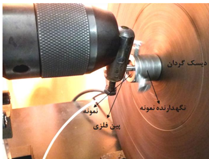
شکل ۲-۱۳: موقعیت نمونه در دستگاه تست سایش
