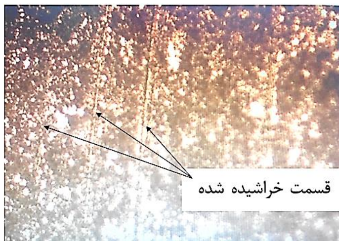
شکل ۳-۱۰ تصویر میکروسکوپ نوری بعد از آزمون سایش
