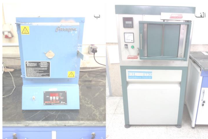
شکل ۲-۷: الف) کوره باکسی برای پخت دما بالا ب) کوره برای پیش پخت و خروج چسب PVA
