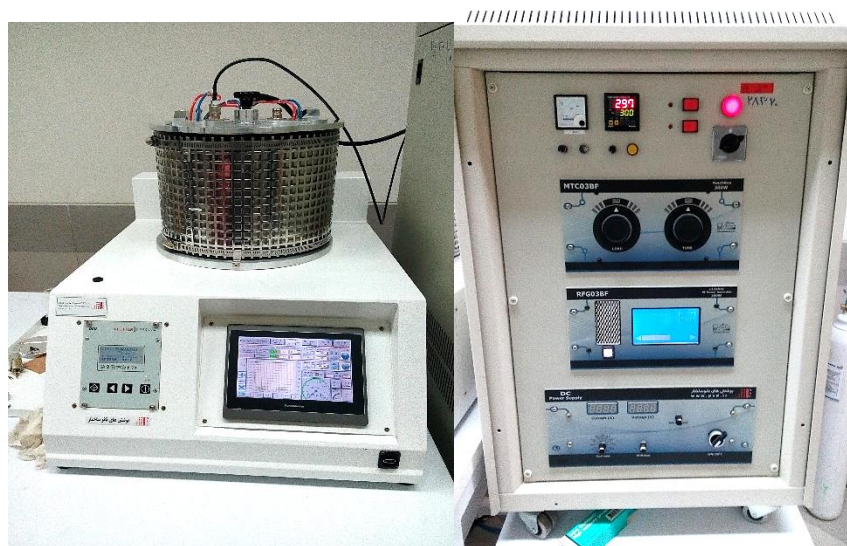
شکل ۳-۴: تجهیزات کند و پاش مورد استفاده در این تحقیق.
