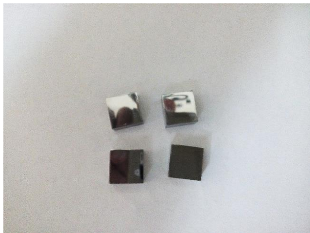
شکل ۳-۲: زیرلایه‌های فولادی آماده سازی شده جهت اعمال پوشش.
