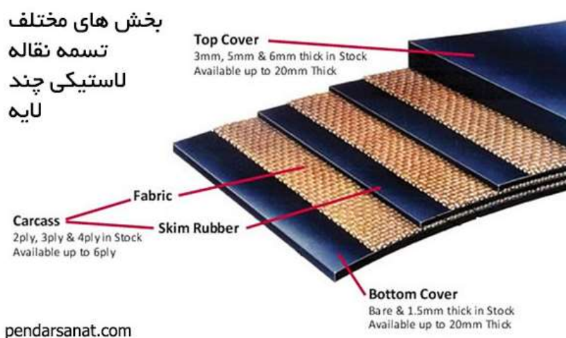
شکل ۴-۵- بخش‌های مختلف تسمه نقاله لاستیکی [۸۳]
