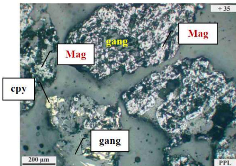
شکل ۴-۲: مقطع صیقلی (۱۰۰۰-۵۰۰+) میکرون
