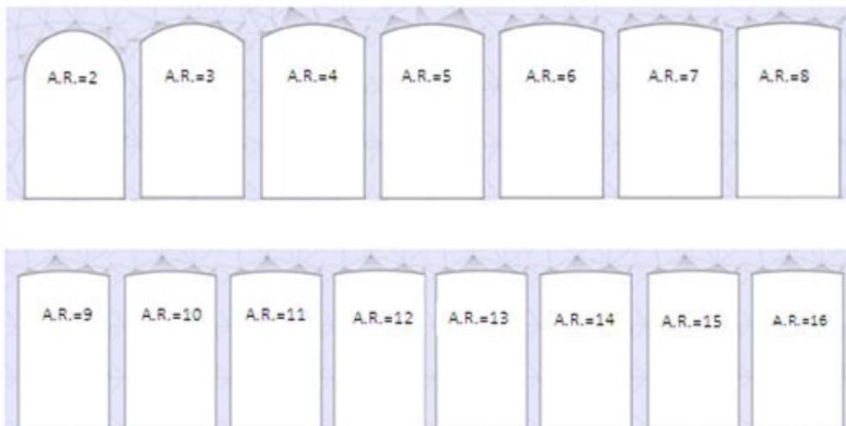
شکل ۲-۱۵: مدل تونل طاقی شکل با عرض ۴ متر و شعاع قوس مختلف (شعاع قوس تونل بر حسب متر A.R.) (Ahmadi et al. 2015)
