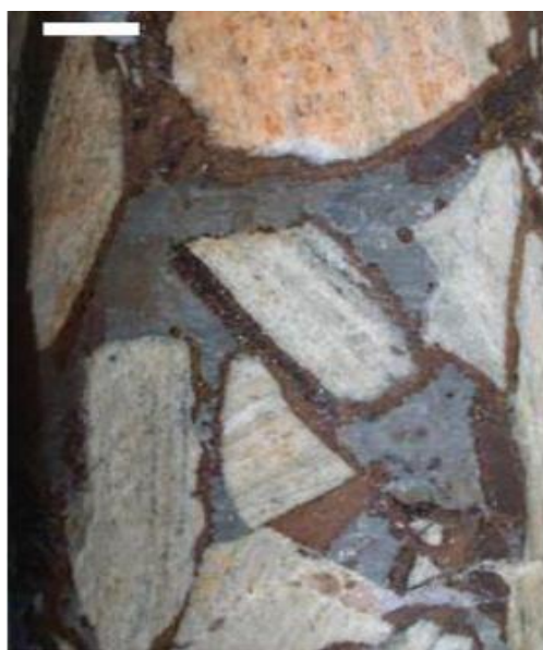
شکل ۳-۴: بافت برشی موجود در زون سولفور که در آن قطعات کربناته و شیبستی زاویه دار به وسیله اسفالریت قهوه‌ای سیمانی شده‌اند و در یک زمینه سیلیسی ریز دانه قرار گرفته‌اند (مقیاس برابر ۱ سانتی متر).
