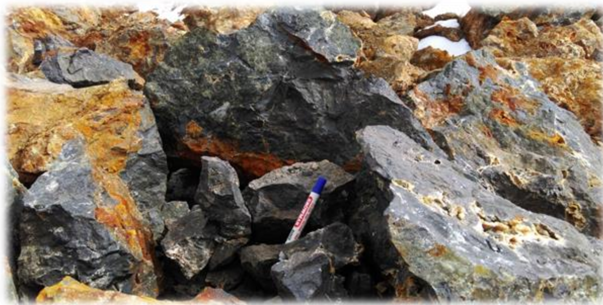
شکل ۳-۳: ماده معدنی سولفور در قسمت روباز معدن سرب و روی انگوران بعد از عملیات آتشفکری
