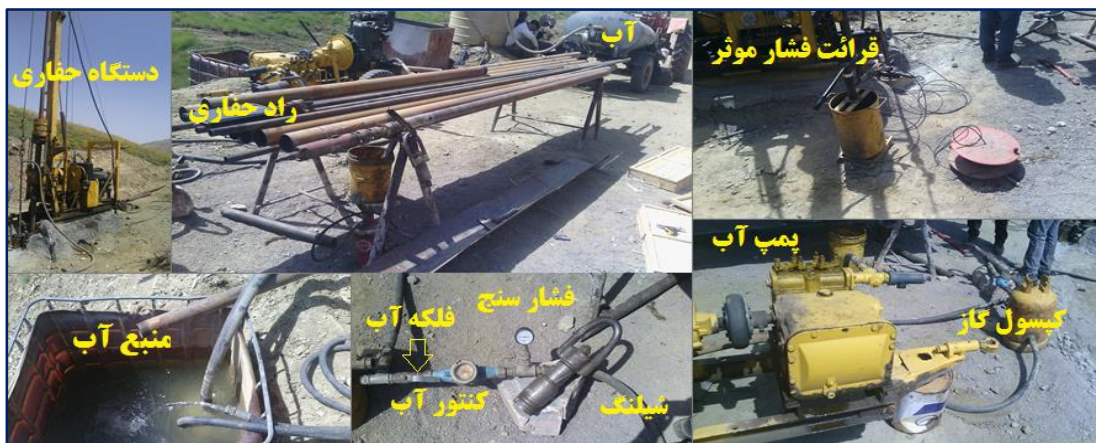
شکل ۴-۱- نمایش شماتیک انجام آزمایش لوژان در معدن سرب و روی انگوران.
