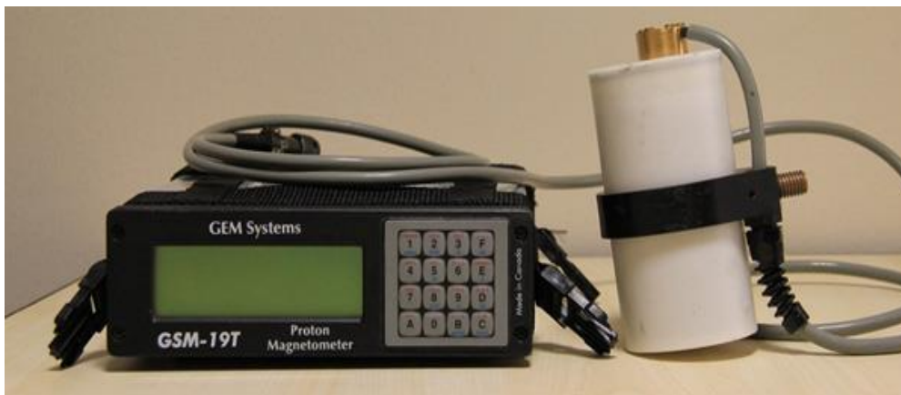
شکل ۵-۵: تصویری از دستگاه مغناطیس سنج پروتون مدل GSM 19T شرکت GEMSYS کانادا
