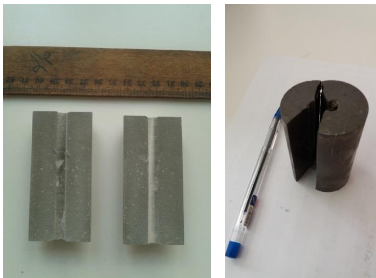
شکل ۵-۷۳: الگوی شکستگی دو سیال در فشارهای جانبی مختلف
