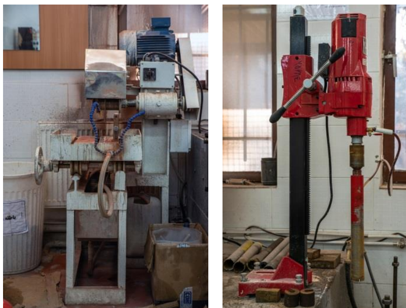
شکل ۴-۲: دستگاه‌های مغزه‌گیر و برش مغزه
