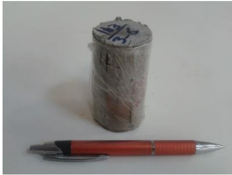
شکل ۴-۲۳: نمونه‌های مخزنی پس از آزمایش مقاومت فشاری تک محوره
