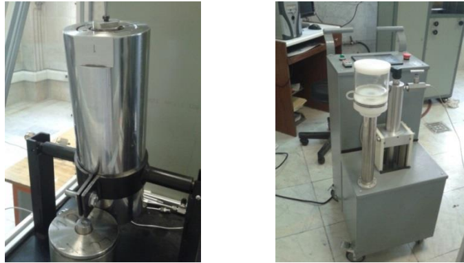
شکل ۵-۵: پمپ تزریق سیال (سمت راست)، مخزن دارای سیال شکست (سمت چپ)
