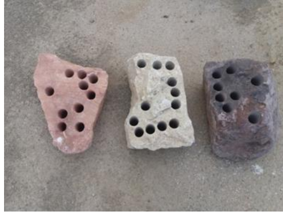
شکل ۴-۳: بلوک‌های سنگی صحرایی مغزه گرفته شده (از راست به چپ ماسه‌سنگ، آهک و توف)
