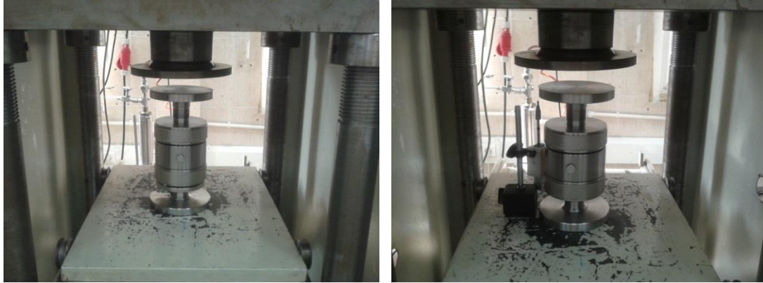
شکل ۴-۲۵: آماده‌سازی نمونه برای آزمایش مقاومت فشاری سه محوره
