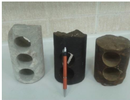
شکل ۴-۵: نمونه سنگ مخزن مغزه گرفته شده
