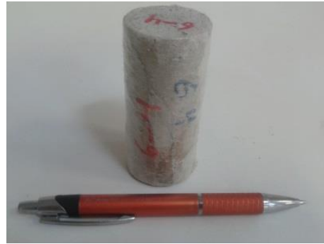
شکل ۴-۲۳: نمونه‌های مخزنی پس از آزمایش مقاومت فشاری تک محوره
