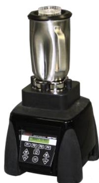
شکل ۴-۷: دستگاه همزن سیمان برای ساخت دوغاب
