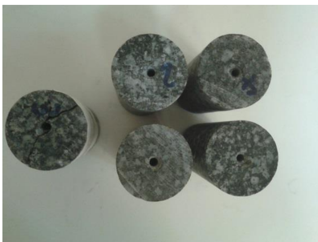
شکل ۵-۵۶: نمونه‌های گرانیت بعد از آزمایش (سمت چپ نمونه آزمایش شده با نرخ ۱۰ میلی لیتر در دقیقه، سمت راست چهار نمونه آزمایش شده با نرخ‌های مختلف تزریق)
