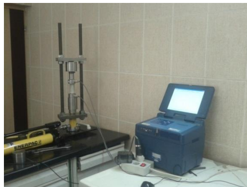
شکل ۴-۱۸: دستگاه آزمایش التراسونیک
