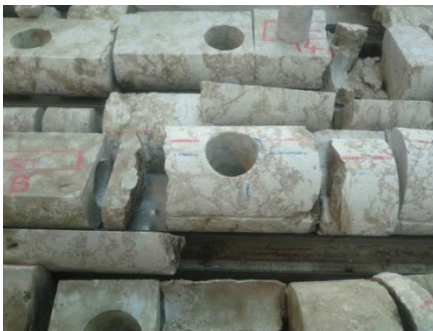
شکل ۴-۵: نمونه سنگ مخزن مغزه گرفته شده
