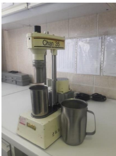
شکل ۵-۹: دستگاه ویسکومتر جهت اندازه‌گیری خواص رئولوژی سیال
