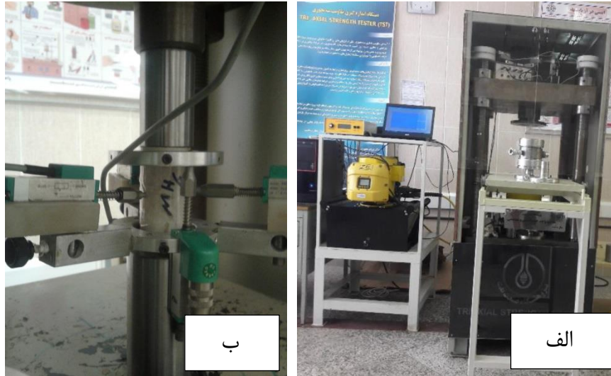
شکل ۴-۲۲: نمایی از دستگاه آزمایش تک محوره و نمونه تحت اعمال بار محوری
