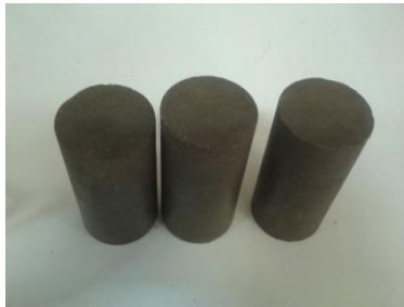
شکل ۴-۴: نمونه مغزه‌های صحرایی تهیه شده برای انجام آزمایش‌های مختلف
