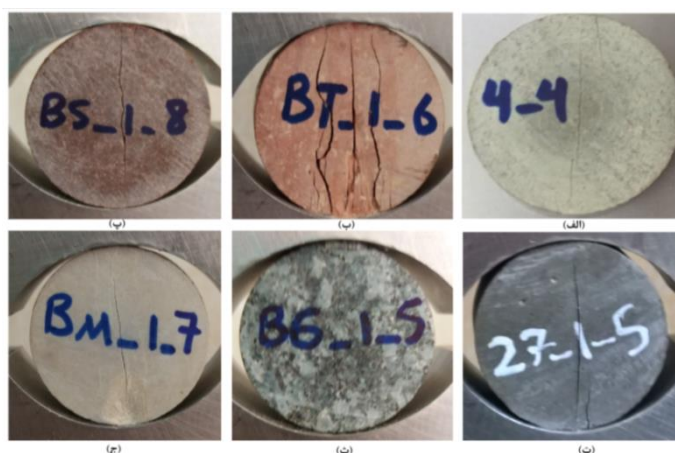
شکل ۴-۲۸: شکست کششی نمونه‌های مختلف تحت آزمایش مقاومت کششی برزیلی
