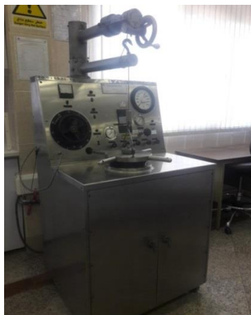
شکل ۴-۱۰: دستگاه عمل‌آوری نمونه در شرایط دما و فشار
