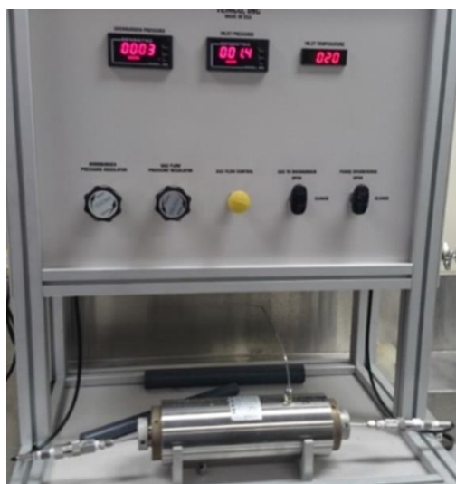
شکل ۴-۱۷: اندازه‌گیری نفوذپذیری با استفاده از گاز خشک
