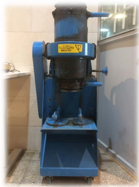
شکل ۳-۲. آسیای میله ای مورد استفاده جهت خردایش نمونه.
