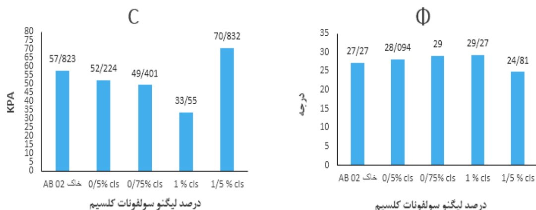
شکل ۴-۴۶: تأثیر درصدهای لیگنوسولفونات کلسیم بر روی چسبندگی (C) و زاویه اصطکاک داخلی (Φ) در خاک AB02
