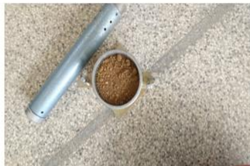
شکل ۴-۱۵: وزن کردن خاک و کوبیدن خاک در سه لایه و قالب تراکم و قرار دادن نمونه در گرمخانه در آزمایش تراکم استاندارد
