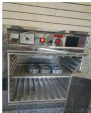
شکل ۴-۱۵: وزن کردن خاک و کوبیدن خاک در سه لایه و قالب تراکم و قرار دادن نمونه در گرمخانه در آزمایش تراکم استاندارد
