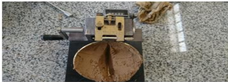
شکل ۴-۱۲: آزمایش حد روانی
