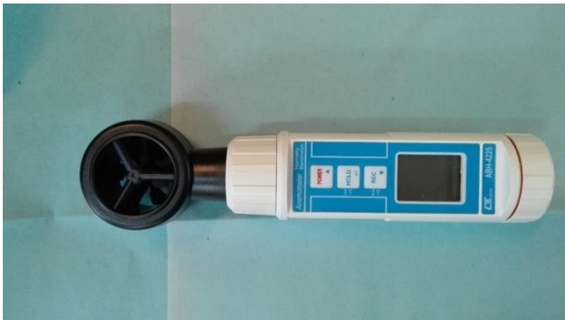
شکل (۷-۳) دستگاه ABH-4225 وسیله اندازه‌گیری سرعت و فشار هوا
