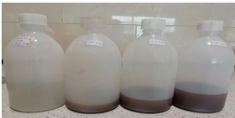
شکل ۳-۴- انجام آزمایش لیچینگ سریالی در بطری‌های پلی اتیلن ۱ لیتری- بطری سمت چپ حاوی محلول حاصل از لیچینگ جداگانه باطله‌های سولفیدی و سه بطری سمت راست برای لیچینگ باطله گل قرمز بوکسیتی در نسبت‌های مختلف
