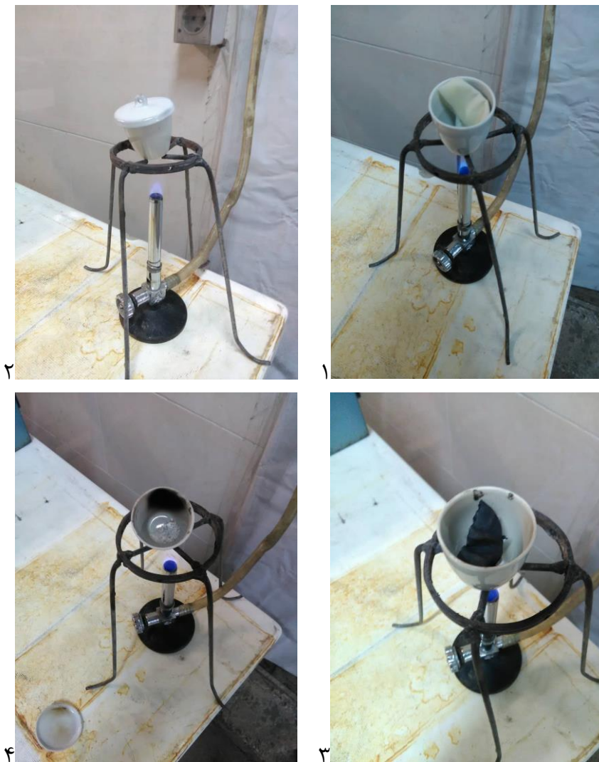
شکل ۴-۴- انجام مراحل سوزاندن فیلتر بدون خاکستر در بوتله چینی برای توزین دقیق ماده جامد باقیمانده روی فیلتر در آنالیز محاسبه میزان سولفات محلول
