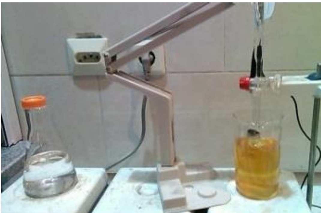
شکل ۴-۵- انجام آزمایش تولید خالص اسیدی چندمرحله‌ای (SeNAG)؛ سمت راست: تیتراسیون محلول نمونه باطله سولفیدی زغالی، سمت چپ: ارلن حاوی سدیم هیدروکسید (NaOH) ۰/۱ مولار
