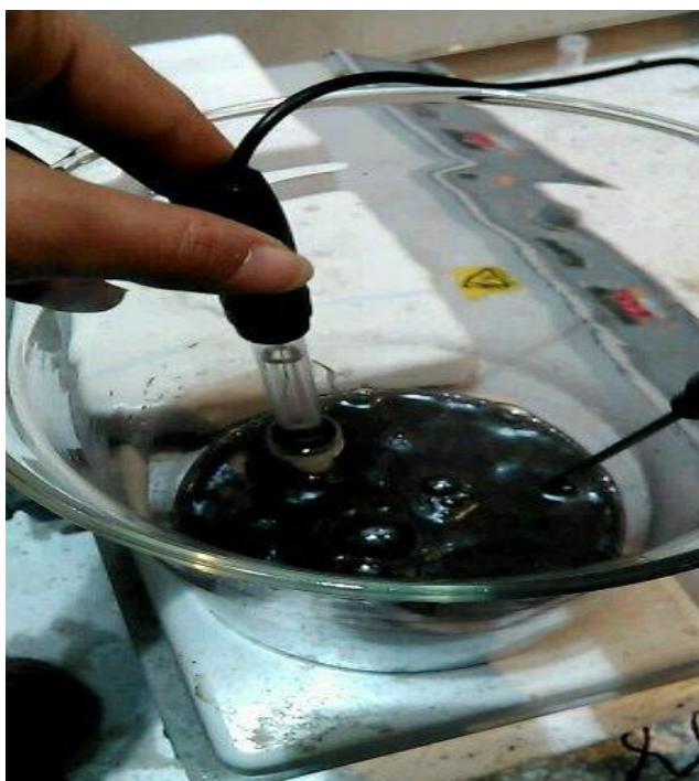
شکل ۳-۲- انجام آزمایش تولید خالص اسید سینتیکی (KNAG) برای باطله سولفیدی زغالی
