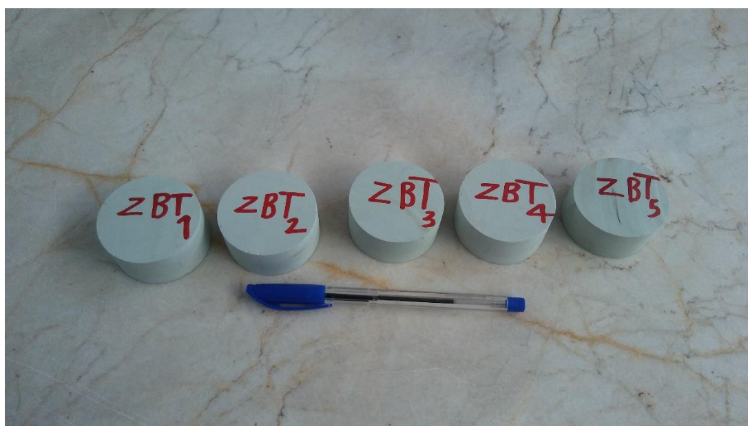
شکل ۴-۸ نمونه‌های دیسکی تهیه شده از بلوک سنگ زئولیت جهت انجام آزمایش‌های بارگذاری فشاری و انتشار آوایی
