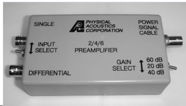
شکل ۲-۱۵: نوعی از تقویت کننده (Grosse and Ohtsu, 2008).
