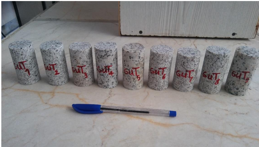
شکل ۴-۵ نمونه‌های استوانه‌ای تهیه شده از بلوک سنگ گرانیت جهت انجام آزمایش‌های بارگذاری فشاری تک محوره و انتشار آوایی
