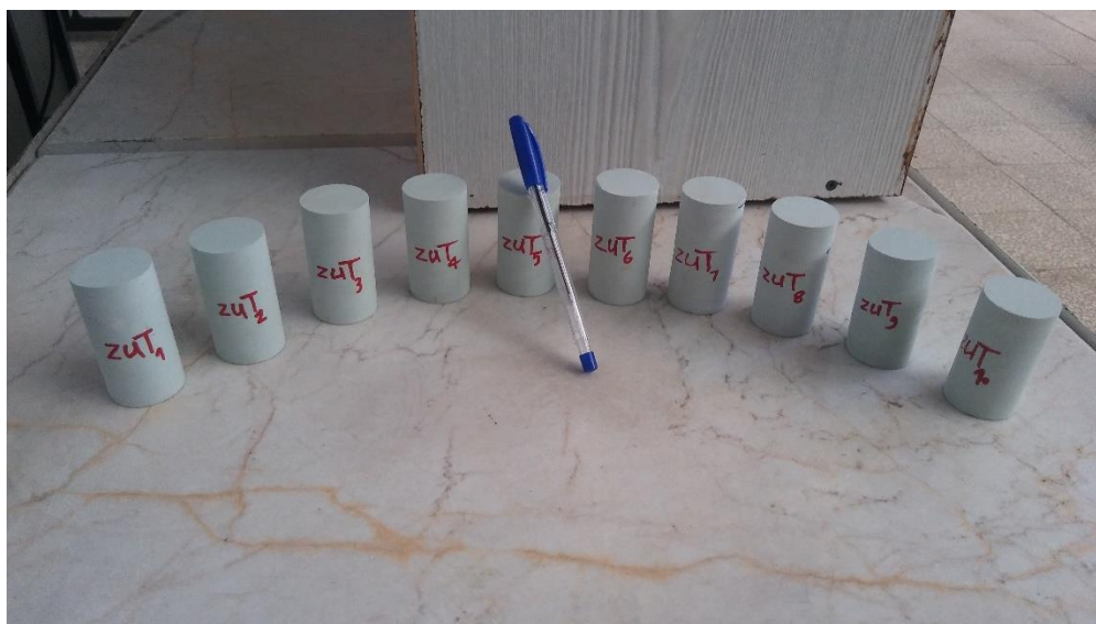
شکل ۴-۷ نمونه‌های استوانه‌ای تهیه شده از بلوک سنگ زئولیت جهت انجام آزمایش‌های بارگذاری فشاری تک محوره و انتشار آوایی
