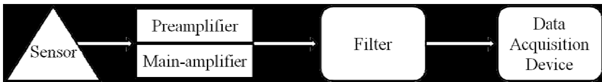
شکل ۲-۱۴: محل نصب سنسور در سیستم انتشار آوایی (Grosse and Ohtsu, 2008)
