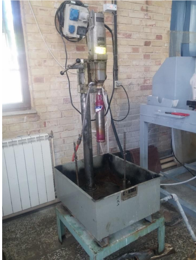
شکل ۱-۰: تصویر دستگاه مغزه‌گیری مورد استفاده.
