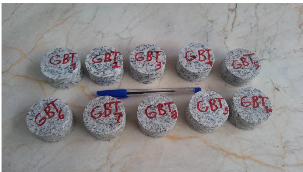
شکل ۴-۶: نمونه‌های دیسکی تهیه شده از بلوک سنگ گرانیت جهت انجام آزمایش‌های بارگذاری فشاری و انتشار آوایی
