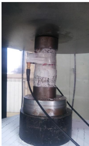
شکل ۴-۱۳: نمونه استوانه‌ای آزمایش سنگ گرانیت
