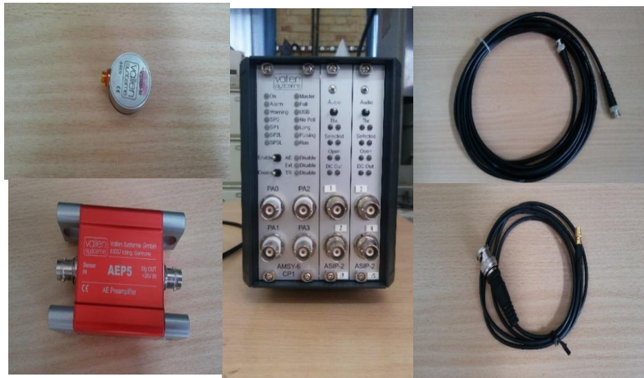
شکل ۴-۱۰: اجزای اصلی سیستم انتشار آوایی AMSY-6
