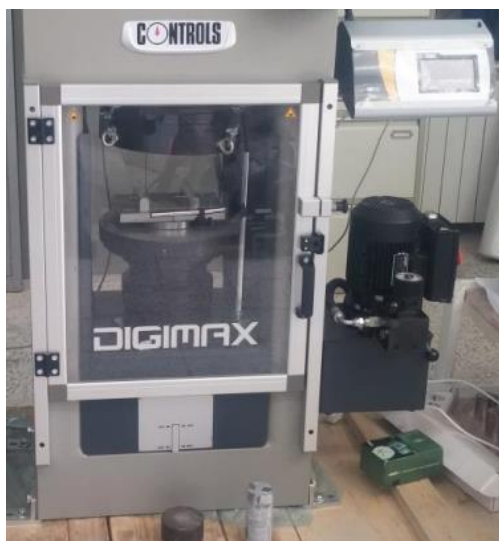
شکل ۴-۹: نمای کلی از دستگاه بارگذاری آزمایش.
