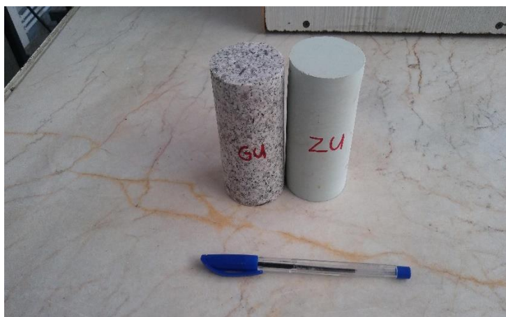
شکل ۳-۰: نمونه‌های استوانه‌ای تهیه شده از بلوک‌های سنگ گرانیت و زئولیت
