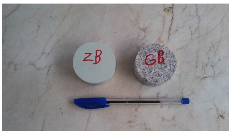
شکل ۴-۴: نمونه‌های دیسکی تهیه شده از بلوک‌های سنگ گرانیت و زئولیت
