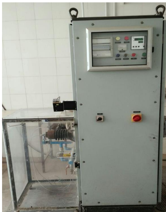
شکل ۳-۵: تصویر دستگاه اتوکلاو واحد تحقیق توسعه-شرکت آلومینای ایران
