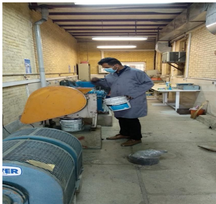
شکل ۴-۳: مرحله سنگ شکنی با سنگ شکن فکی
