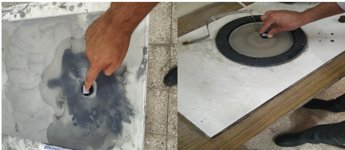
شکل (۸-۴): روش تهیه مقطع صیقلی از نمونه زغالی.
