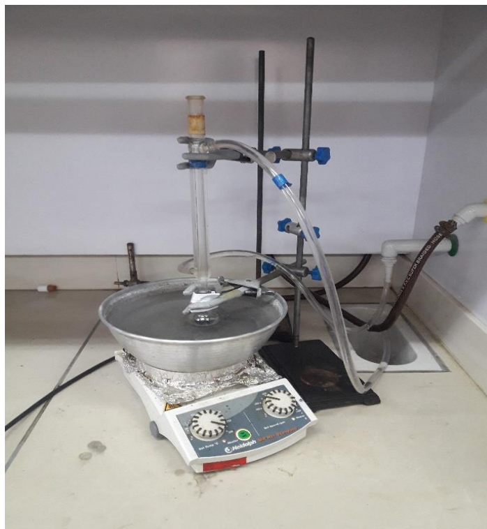
شکل ۳-۶: ست آپ آزمایشگاهی برای انجام فرآیند رفلکس و اتصال نانو لوله‌های کربن به کائولینیت.
