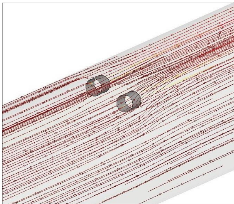
شکل ۵-۱۲- بردارهای سرعت در تونل مجهز به جت فن های شرکت Korfmann در حالت تهویه نرمال
