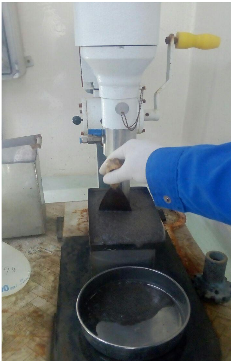
شکل ۷-۸ سلول فلوتاسیون آزمایشگاهی شرکت دانش فرآوران
