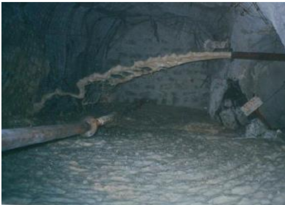
شکل ۲-۱۰: تصویر فوم سه فازی تولید شده (Wang-xing et al., 2011)
