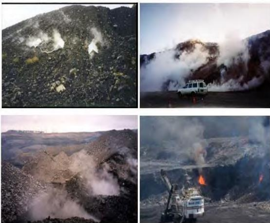
شکل ۲-۹: نمونه‌هایی از تأثیرات زیست‌محیطی خودسوزی زغال‌سنگ (Glenn et al., 2015)
