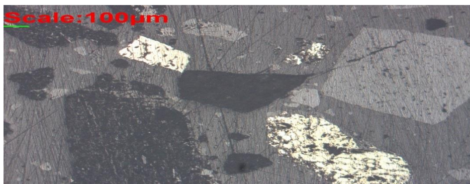
شکل ۴-۱۱: عکس تهیه شده از تست مقطع صیقلی حاوی پیریت برای معدن ماهان
