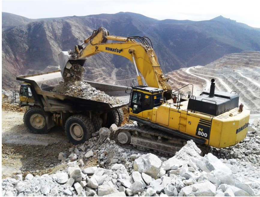
شکل ۴-۵. بارگیری دامپتراک توسط شاول
