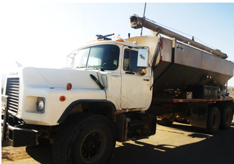
شکل ۴-۴. دستگاه خرج گذاری معدن مس سونگون (آنفوتراک)
