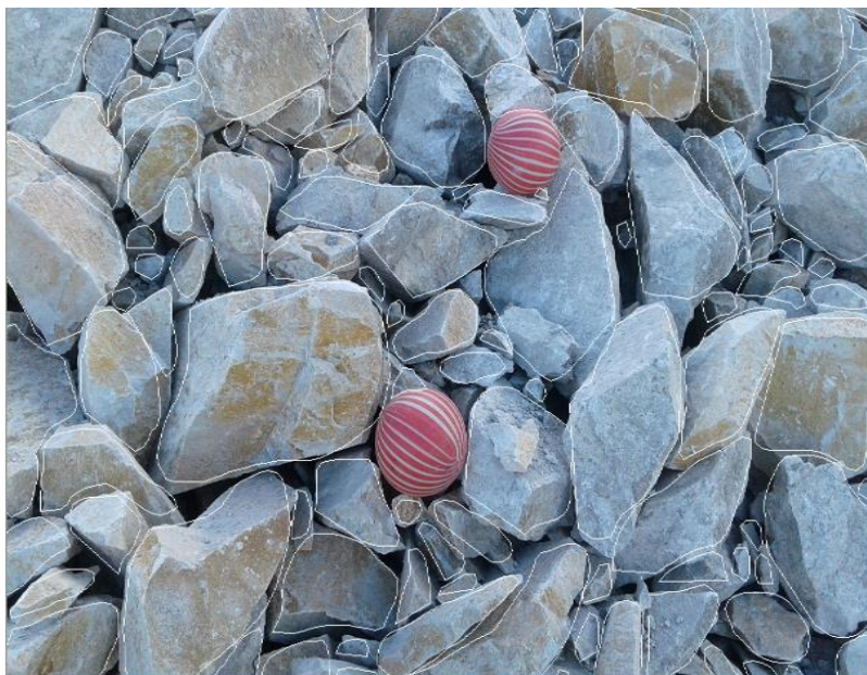
شکل ۳-۵. نمونه عکس آنالیز شده دستی در نرم افزار Goldsize
