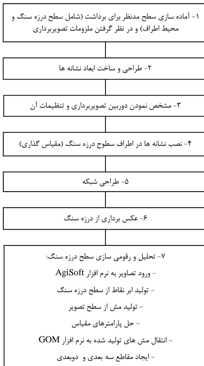
شکل ۳-۳- روندنمای استخراج مقاطع سطح زبر درزه سنگ در روش فتوگرامتری برد کوتاه
