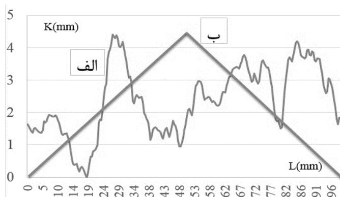
شکل ۴-۲- دو نمونه سطح زبر درزه سنگ (الف و ب) با مقادیر K یکسان اما وضعیت زبری کاملاً متفاوت
