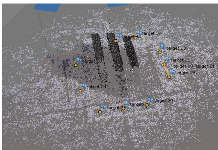
شکل ۳-۱۲- ابر نقاط ایجاد شده بر روی سه نمونه سنگ گرانیت و نشانه‌های شناسایی شده توسط نرم‌افزار برای مشاهده وضعیت تراکم نقاط، در شکل ۳-۱۳ ابر نقاط تشکیل شده در سطح درزه سنگ نمونه گرانیتی نشان داده شده است. همان‌طور که مشاهده می‌شود با ترسیم دو خط به طول‌های ۵/۱ و ۴/۸ میلی‌متر در طول سطح مورد نظر بیش از ۳۰ نقطه محاسباتی پیاده شده است که امکان انجام محاسبات مربوط به پردازش تصویر و دقت مورد نیاز برای تحلیل‌های این تحقیق را میسر می‌سازد.
