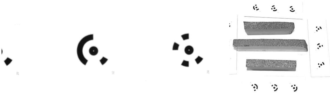
الف- خط‌کش‌های مقیاس ب- نمونه نشانه‌های استفاده شده در تصویر برداری از درزه‌سنگ‌ها
