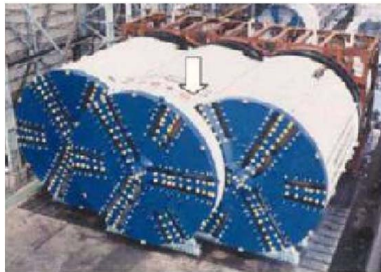
شکل ۲-۸ سپر دومقطعی عمودی و ماشین سپر سه مقطعی (Goto T et al 2005)
