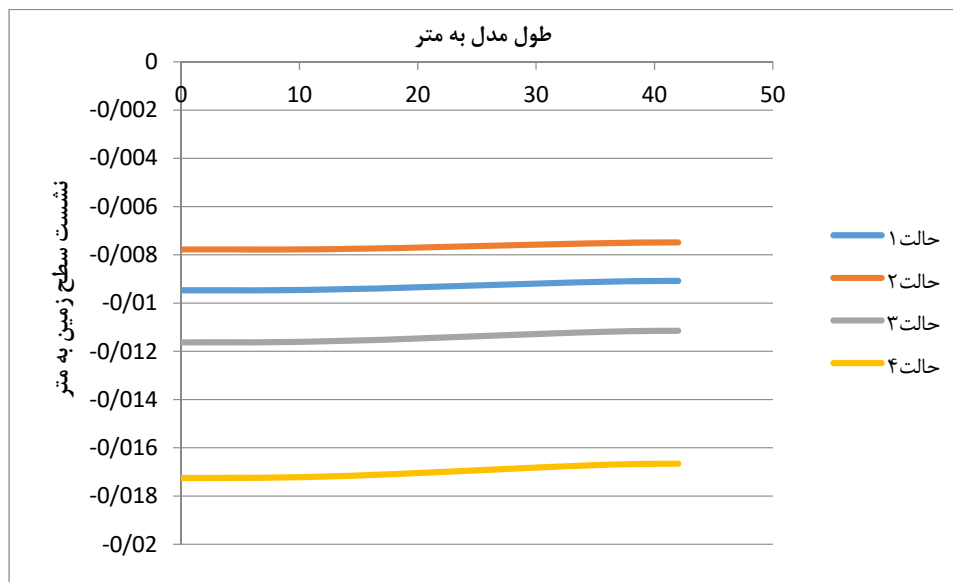
شکل ۶-۵ پروفیل طولی نشست سطح زمین در روش پیش‌نگهدارنده‌ی طاق بتنی برای مقادیر مختلف مدول الاستیسیته المان‌های نگهداری
