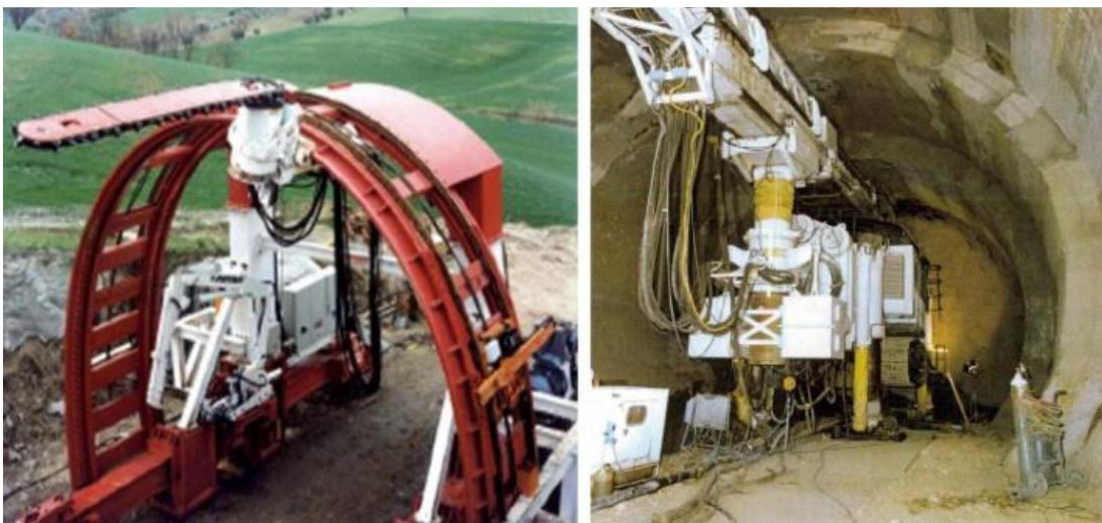
شکل ۲-۹ نمایی از ماشین پیش تونل سازی (Lunardi, P 2005)
