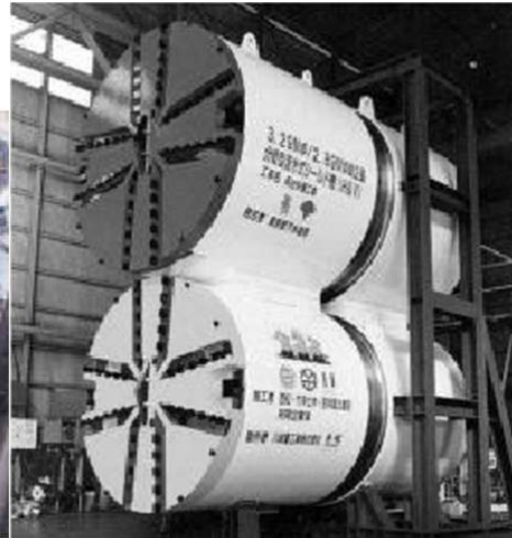
شکل ۲-۸ سپر دومقطعی عمودی و ماشین سپر سه مقطعی (Goto T et al 2005)
