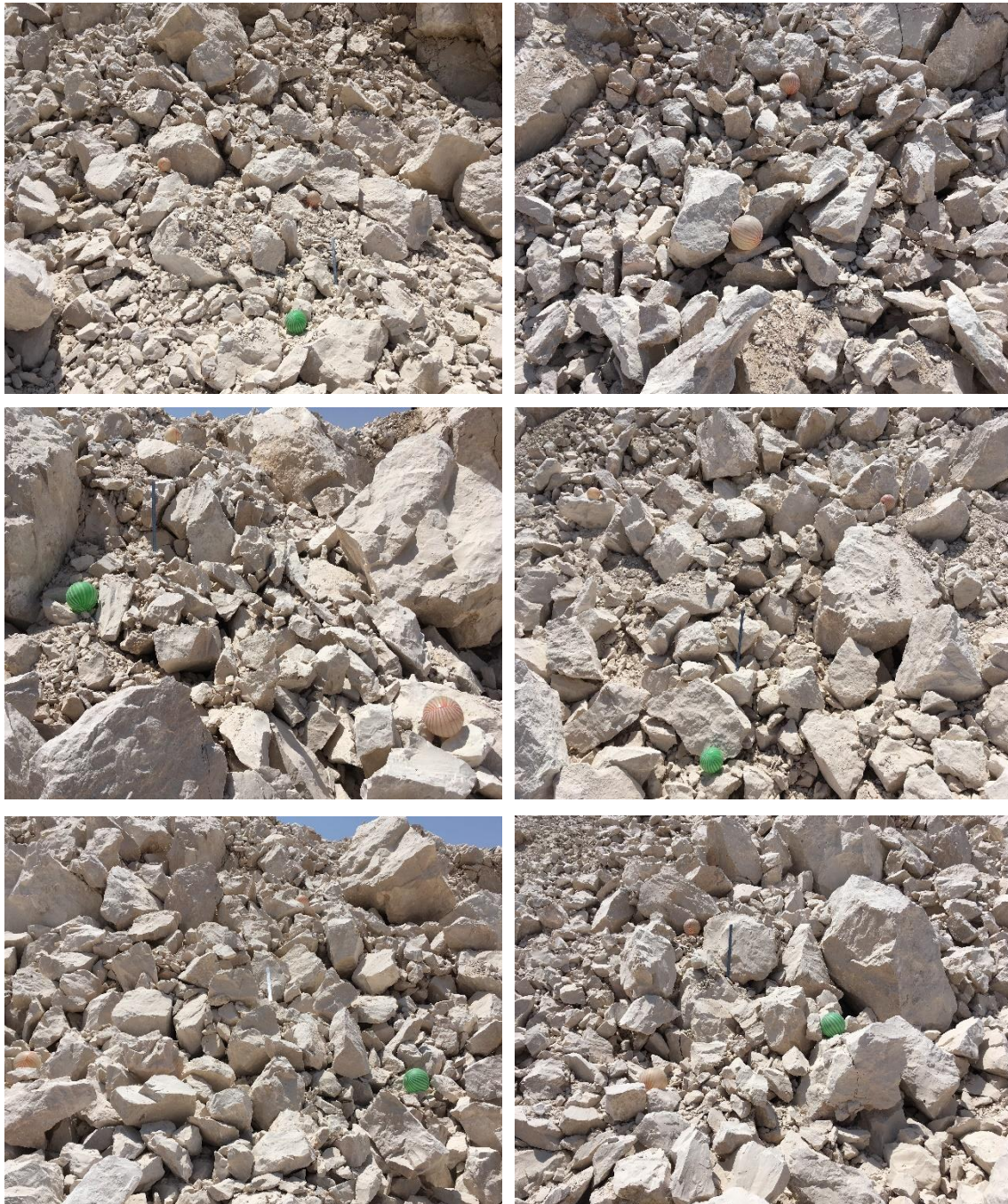
شکل (۴ - ۳۳): خردشدگی حاصل از آتشباری آزمایشی شماره یک در پله شرقی معدن سنگ آهک جاجرم
