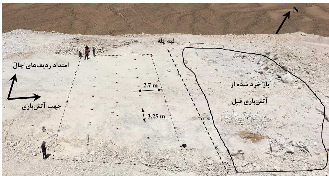
شکل (۴ - ۴۰): آرایش چال‌ها و راستای آتش‌باری آزمایشی شماره سه در پله شرقی معدن سنگ آهک جاجرم
