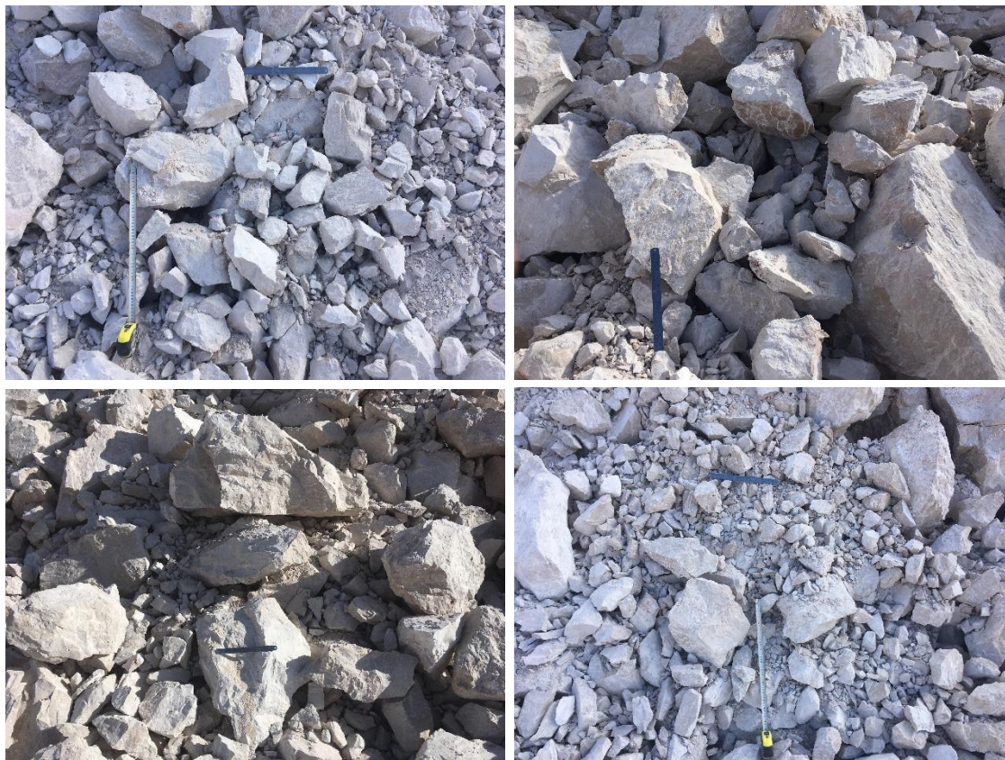
شکل (۴ - ۱۶): تصاویر تهیه شده از قسمت‌های مختلف کپه انفجاری برای پردازش تصویر ابعاد خرد شده بر اثر آتش‌باری در بلوک شرقی معدن سنگ آهک جاجرم
