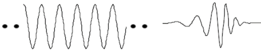
شکل ۳-۶. سمت چپ نمای یک موج (سینوسی) و سمت راست نمای یک موجک است [Fogal, 2009]
