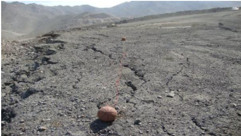
شکل ۴-۹: عقب زدگی پشت سینه کار کروکی Cn-122-1540
