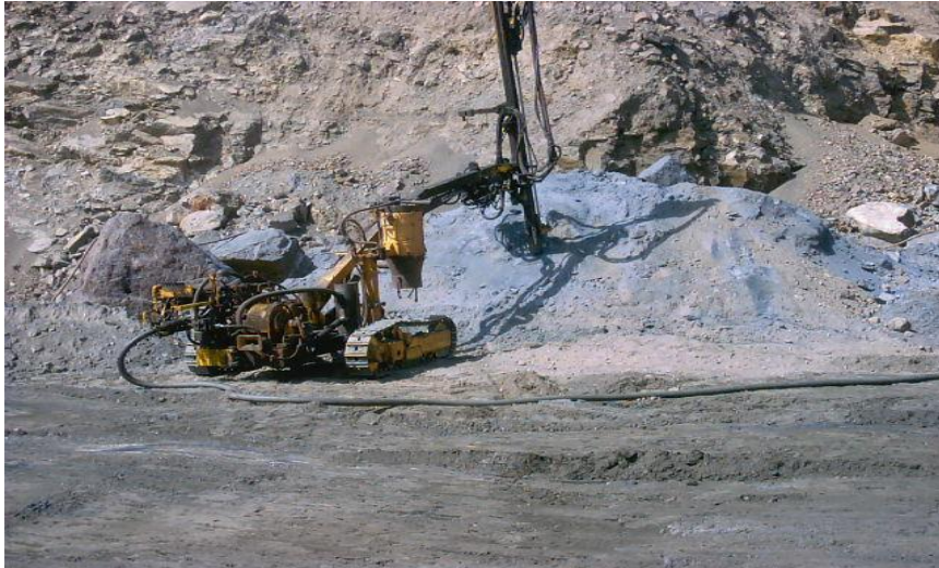
شکل ۴-۸: وجود پاشنه در کف کروکی Cn-149-1540 و حفاری ثانویه
