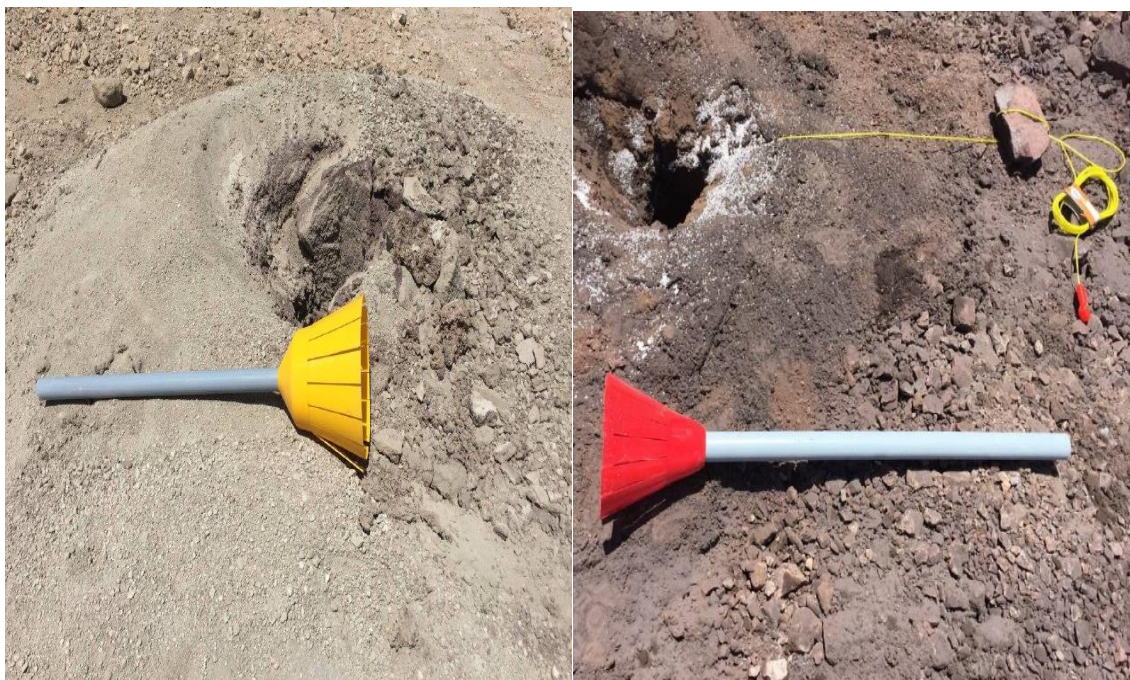
شکل ۴-۱۳: دو نمونه از پلاگ های استفاده شده در آتشیاری
