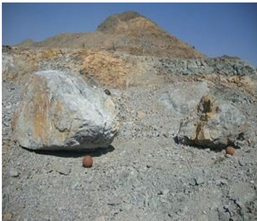
شکل ۴-۷: نتیجه یک انفجار نامناسب در کروکی Cn-149-1540
