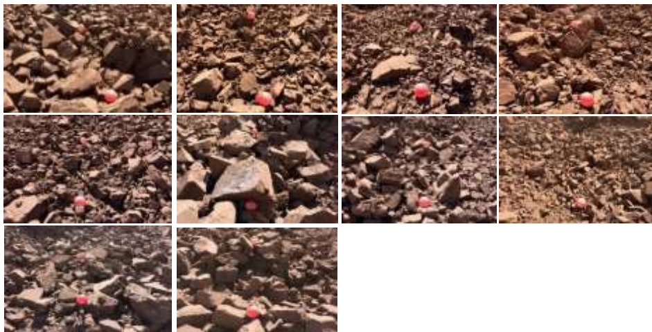
شکل ۱۶: خردایش سنگ‌های حاصل از انفجار ماده بوکسیت در سینه‌کار میانی معدن تاگویی ۳
