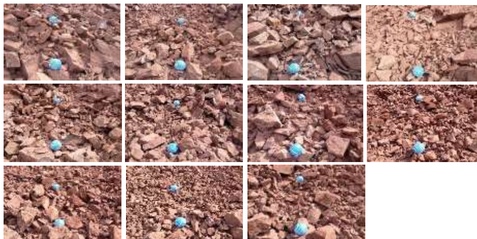
شکل ۱۰: خردایش سنگ‌های حاصل از چهارمین انفجار آزمایشی انفجار در جبهه کار ۲- غربی معدن تاگویی
