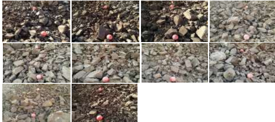
شکل ۴-۵: خردایش سنگ‌های حاصل از اولین انفجار آزمایشی انفجار در جبهه کار ۲ معدن تاگویی ۲.
