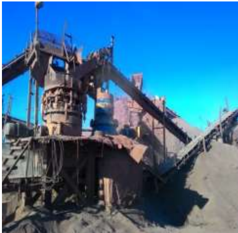
ب- سنگ شکن های مخروطی استاندارد (دانه ریز) و مخروطی استاندارد (دانه درشت)
