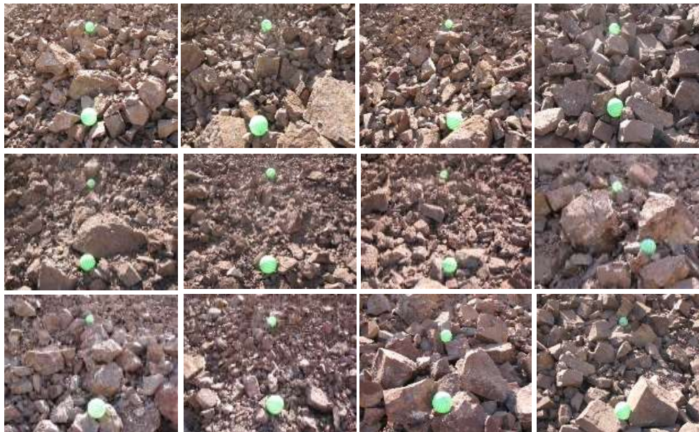
شکل ۷: خردایش سنگ‌های حاصل از انفجار ماده معدنی بوکسیت در سینه‌کار میانی معدن تاگویی ۳
