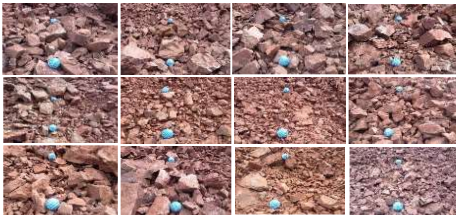
شکل ۸: خردایش سنگ‌های حاصل از سومین انفجار آزمایشی انفجار در جبهه کار ۲- شرقی معدن تاگویی
