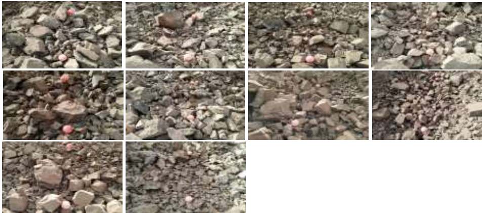
شکل ۲: خردایش سنگ‌های حاصل از دومین انفجار آزمایشی انفجار در جبهه کار ۳ معدن تاگویی ۲
