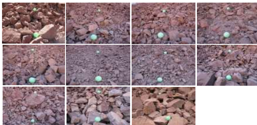
شکل ۴: خردایش سنگ‌های حاصل از انفجار ماده معدنی بوکسیت در سینه کار لنز معدن گلپین ۶
