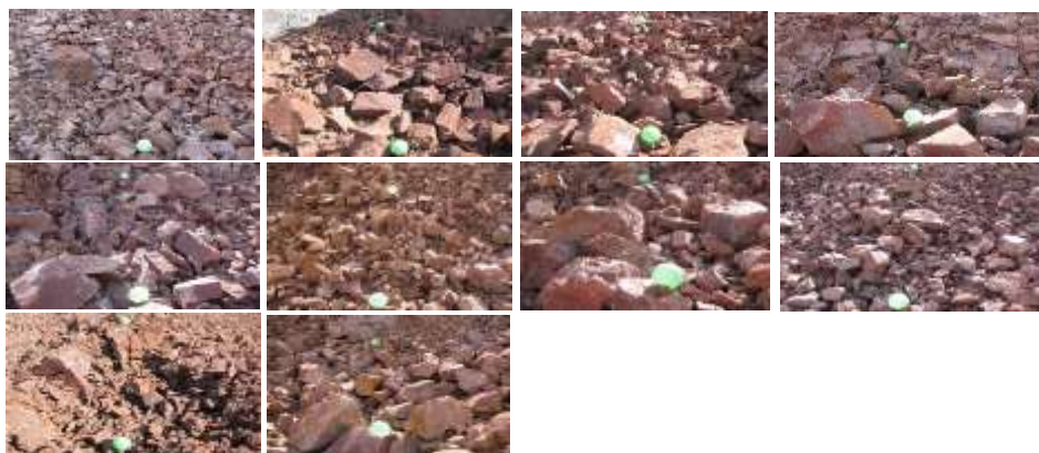
شکل ۴-۱: خردایش سنگ‌های حاصل از انفجار ماده معدنی بوکسیت در سینه‌کار غربی معدن گلبینی ۲.
