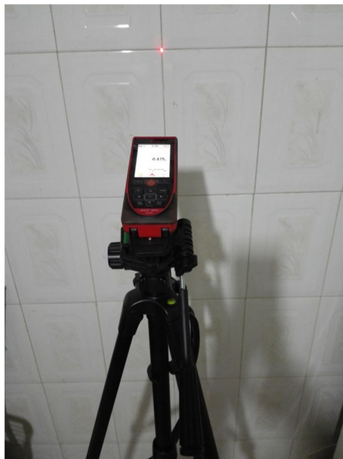
شکل ۴-۱۹- تصویر فاصله‌یاب لیزری نصب شده بر روی سه‌پایه
