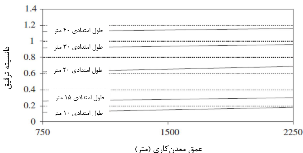
شکل ۳-۲۹- تأثیر عمق در مقدار دانسیته ترقیق در حالت \sigma_3=0 Mpa (Henning and Mitri, 2007)
