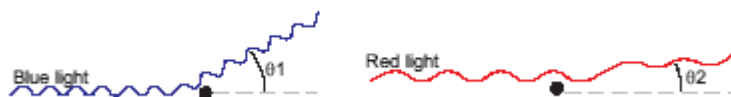
شکل ۳-۸- اثر پراکنش ری لی، طول موج‌های کوتاه‌تر بیشتر دچار پراکندگی می‌شوند [ITC 2001]
