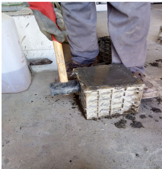
شکل ۴-۴- زدن چکش لاستیکی در هر لایه از ضخامت بتن
