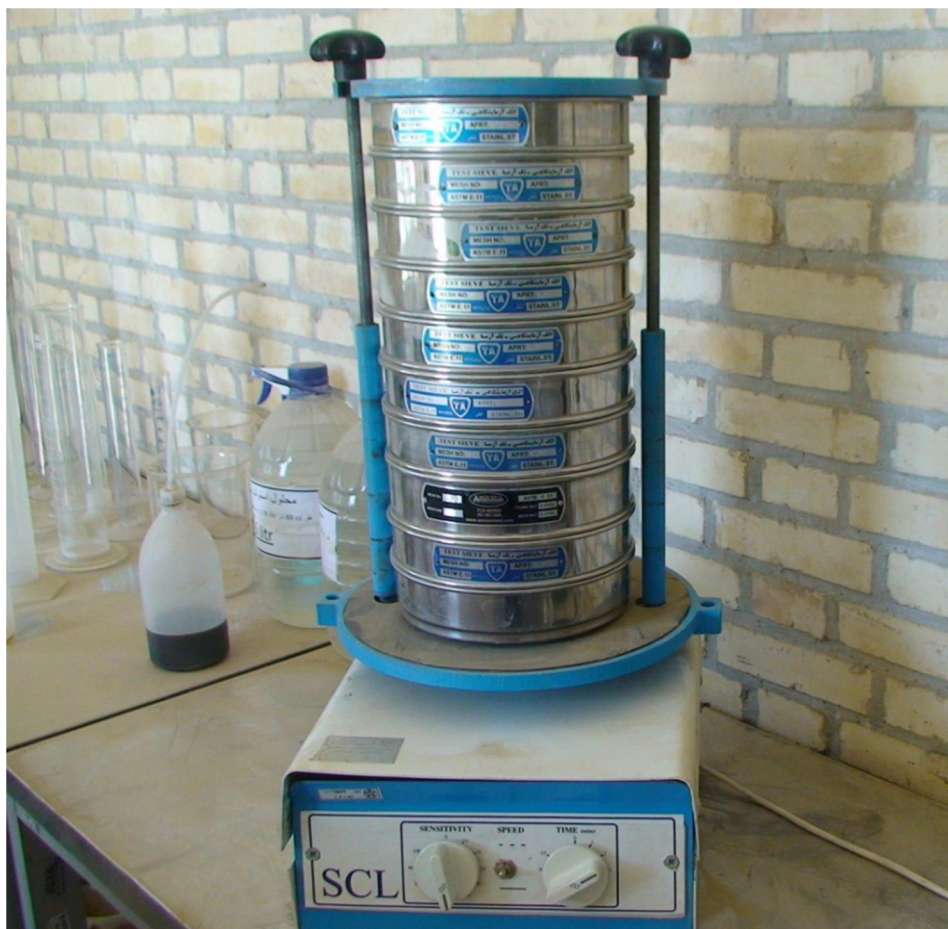
شکل ۴-۱- سری سرندهای مورد استفاده در آزمایش دانه‌بندی مصالح سنگی پرکننده بتنی
