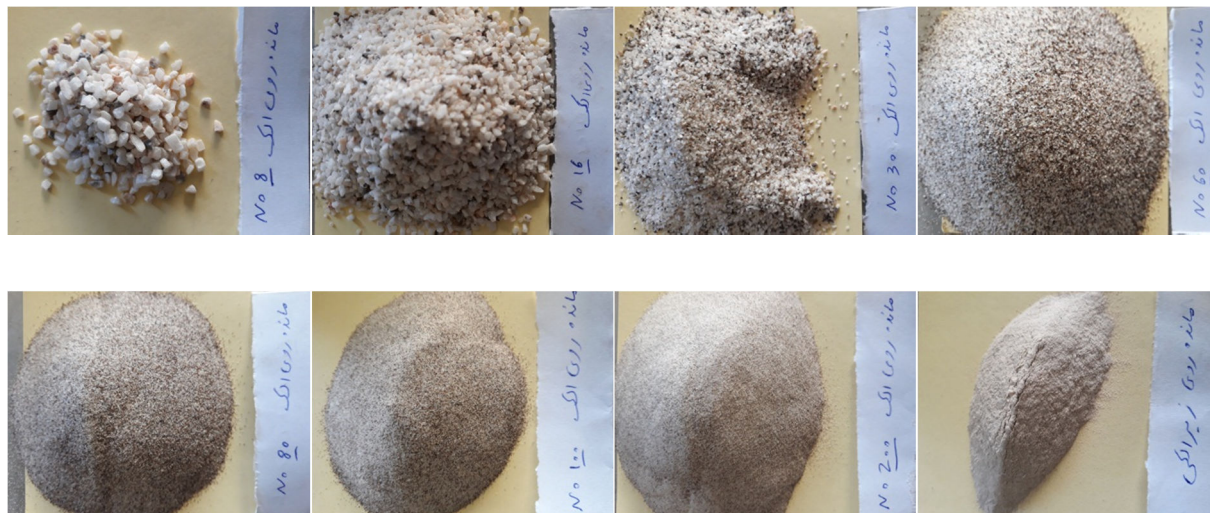
شکل ۴-۳۷- مقادیر باریت باقی مانده روی هر سری از الک‌ها
