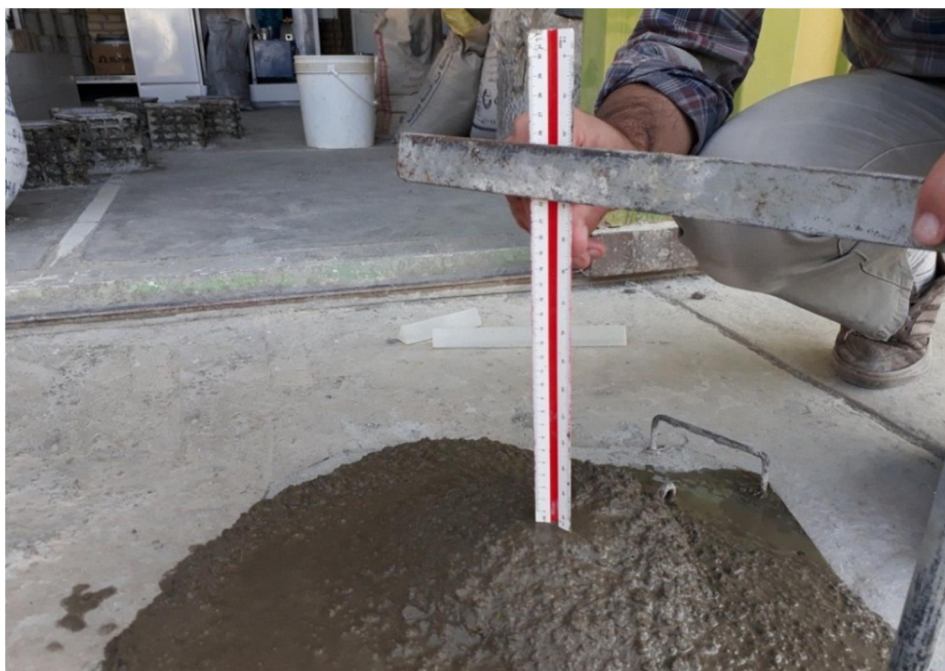
شکل ۴-۱۰- تعیین میزان اسلامپ بتن پرکننده
