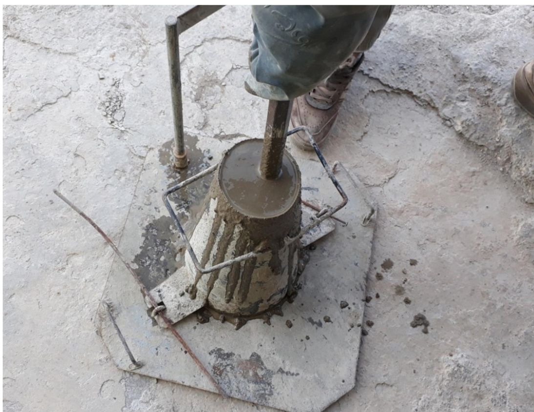
شکل ۹-۴- نمونه آزمایش اسلامپ انجام شده برای تعیین روانی پرکننده بتنی
