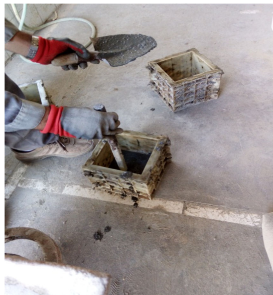
شکل ۴-۳- ریختن لایه‌ای بتن و زدن میله تراکم فلزی در هر لایه
