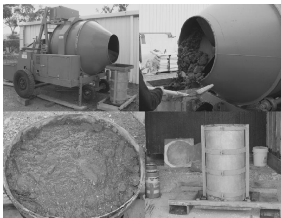
شکل ۲-۱۲- تصویری از ساخت پرکننده بتنی در معدن کاسموس استرالیا (Saw et al., 2013)
