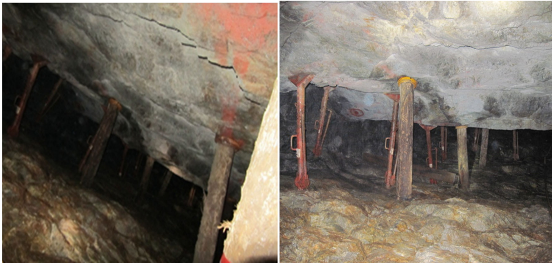
شکل ۷-۲- تصاویری از کارگاه‌های روش استخراج ستونی (نیک گفتار، ۱۳۹۱)
