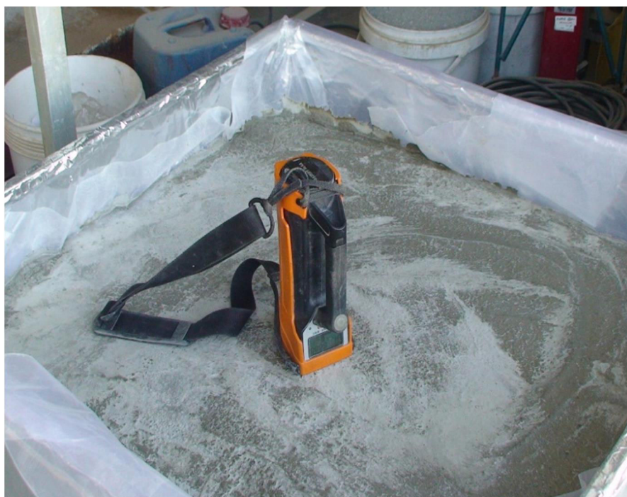
شکل ۴-۱۴ - تصویری از انجام آزمایش پرتوزایی در سطح پرکننده بتنی هیدرولیکی
