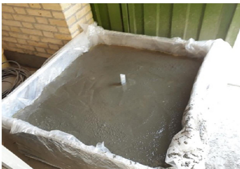
شکل ۲۷-۴ - پرکننده بتنی هیدرولیکی ریخته شده در مجاور کانسنگ اورانیوم
