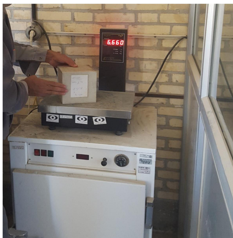
شکل ۷-۴- توزین نمونه‌های بتنی برای بدست آوردن وزن مخصوص نمونه‌ها
