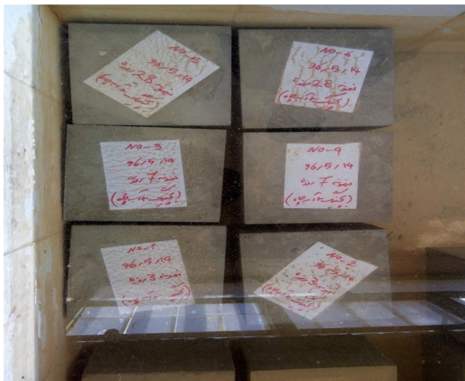
شکل ۴-۵- عمل آوردن نمونه‌های بتنی ساخته شده در حوضچه آب
