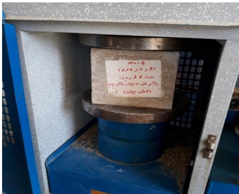
شکل ۴-۲۶- آزمایش مقاومت فشاری نمونه مکعبی از پرکننده بتنی هیدرولیکی ساخته شده با ماسه رودخانه‌ای
