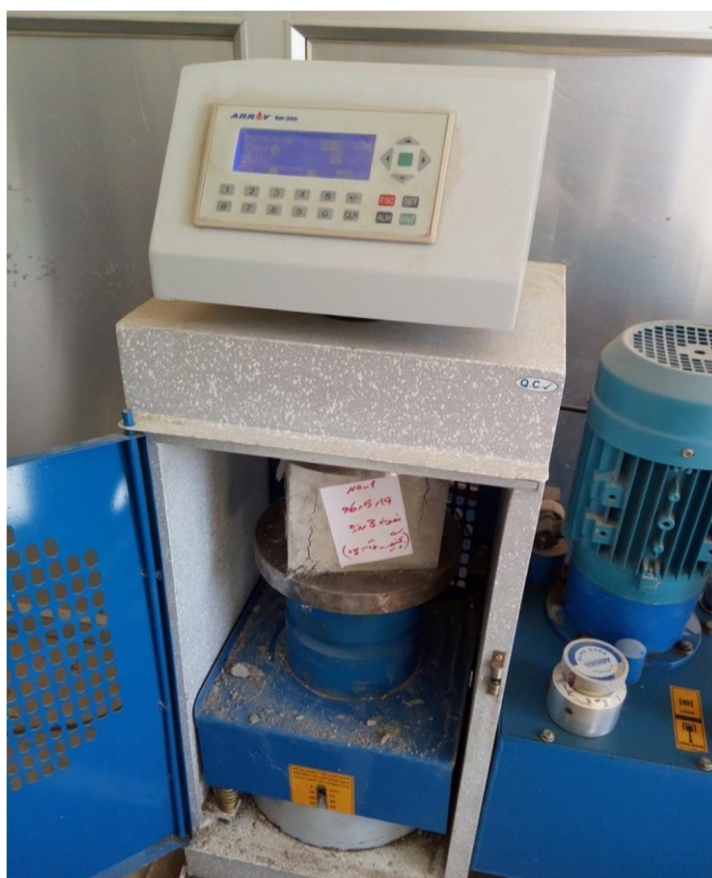
شکل ۴-۶- دستگاه جک بتن شکن برای انجام آزمایش مقاومت فشاری تک محوری
