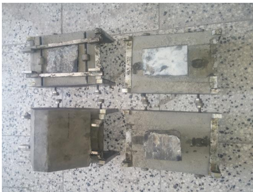
شکل ۳-۸: وسیله قالب‌گیری نمونه‌ها و نمونه قرار گرفته در مخلوط گچ و سیمان
