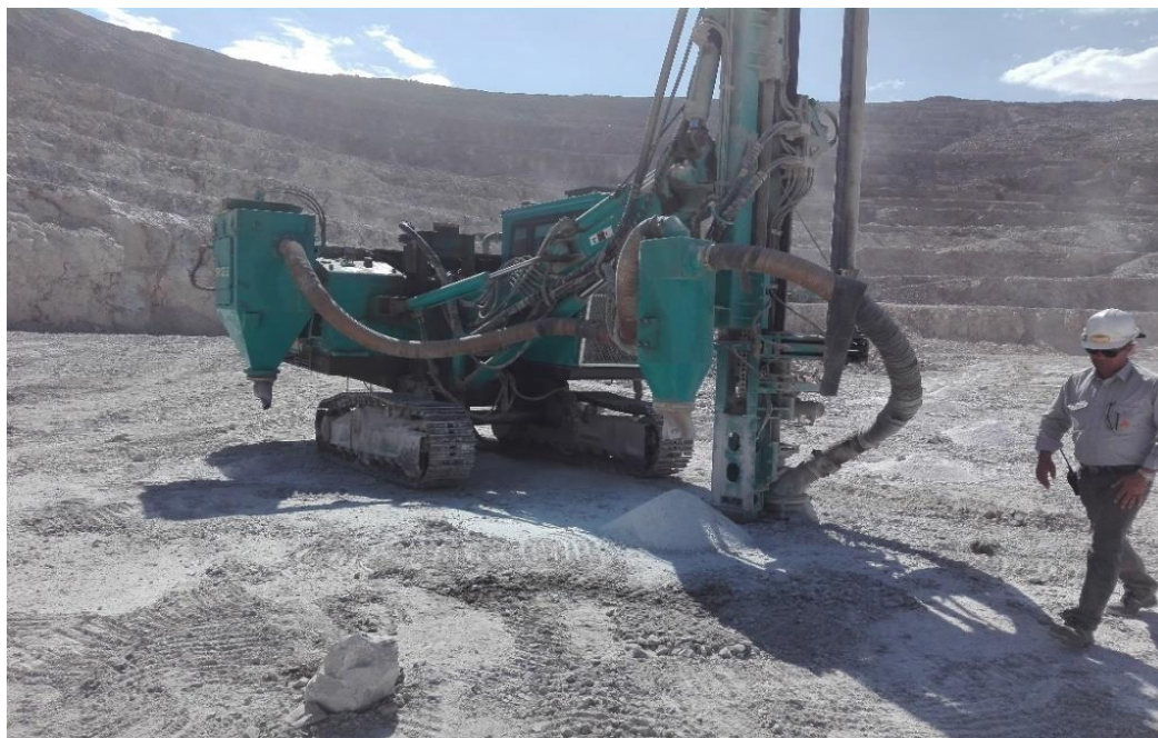
شکل ۴-۵- دستگاه حفاری چال‌های انفجار موجود در معدن
