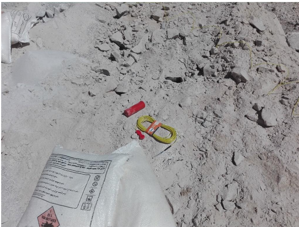
شکل ۴-۶- بوستر، چاشنی نائل و آنفوی استفاده شده در معدن
