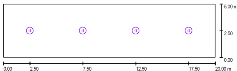
شکل ۳-۶- پلان طراحی شده قرارگیری روشنایی‌ها در فضای تونل
