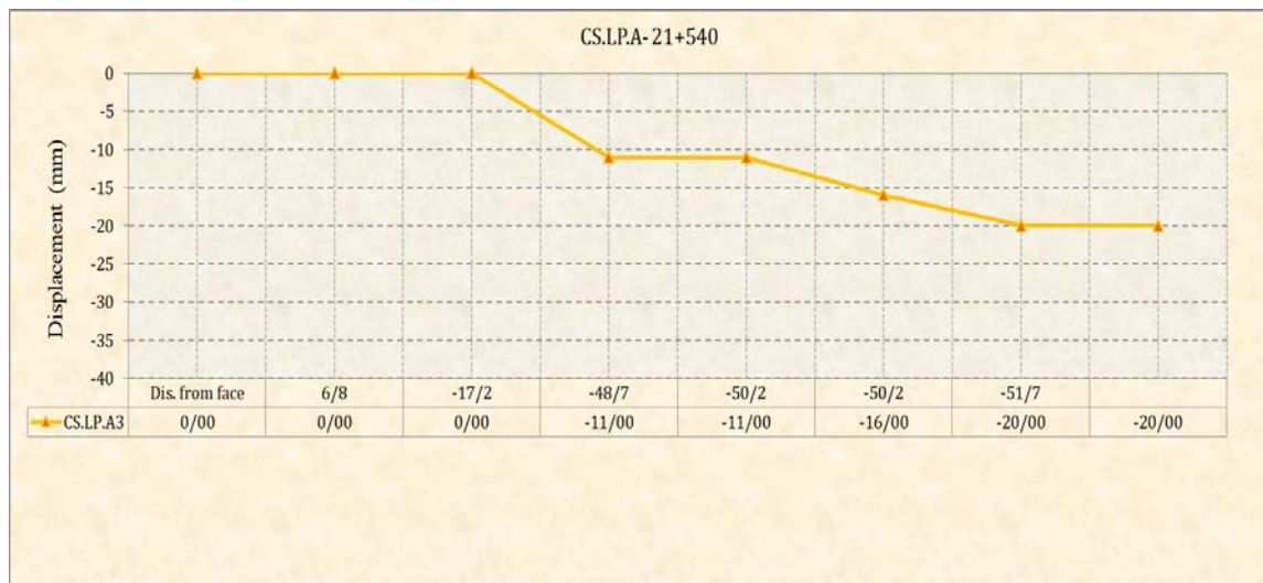
شکل (۵-۱۷): حداکثر نشست اندازه‌گیری شده از ابزار دقیق در کیلومتر ۲۱+۵۴۰ پس از حفاری
