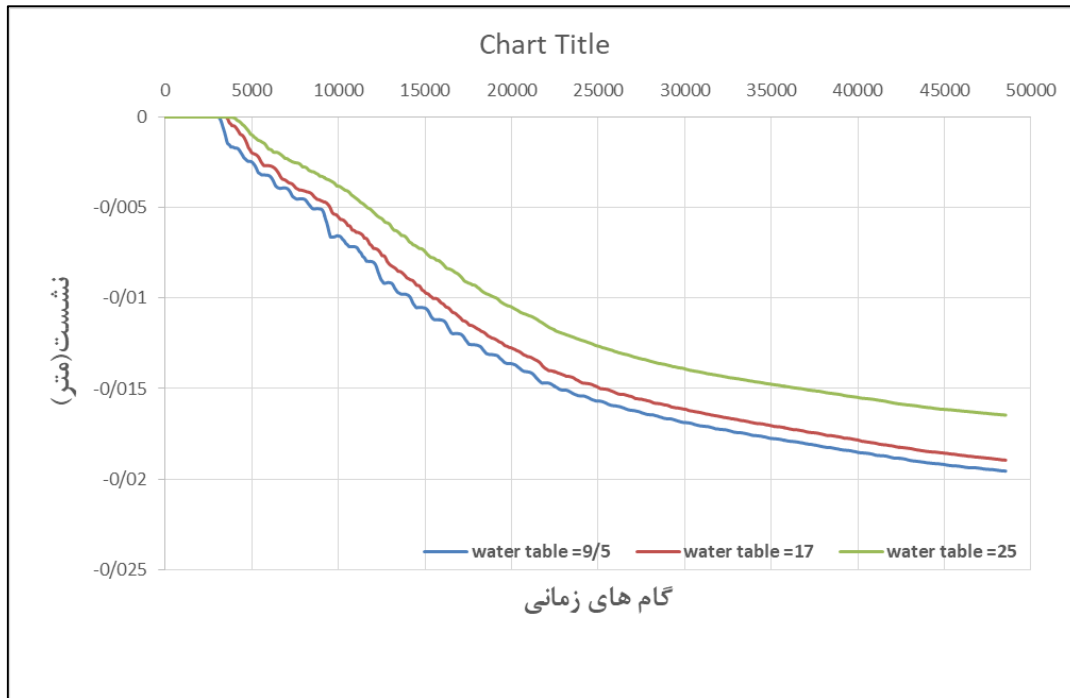
شکل (۶-۱۱): نشست ایجاد شده در سطح زمین در متر از ۶/۸ متر
