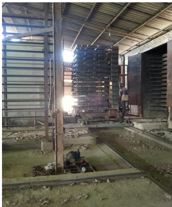
شکل (۳-۱۰) حمل خشت‌های سوار بر پالت توسط دستگاه فینگر
