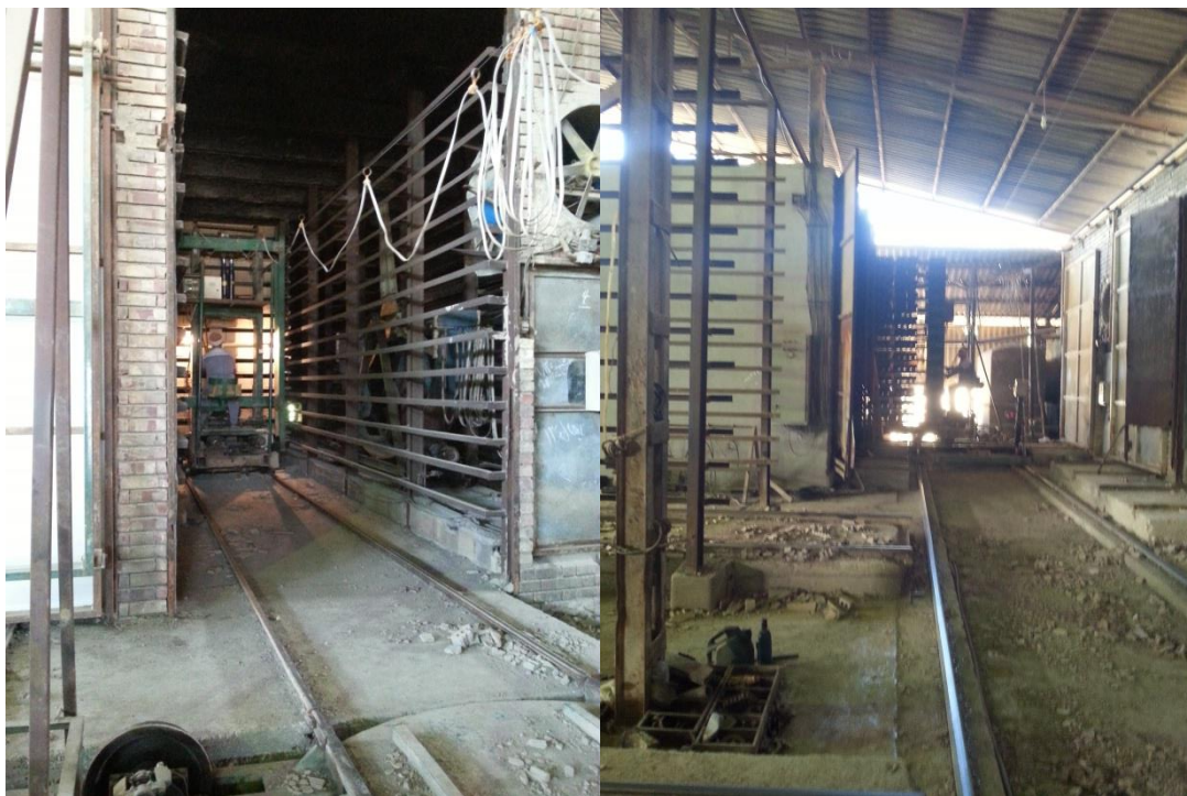
شکل (۱۱-۳) قرار گرفتن خشت‌های سوار بر پالت در اتاق خشک‌کن توسط دستگاه فینگر
