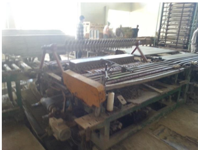
شکل (۳-۷) دستگاه برش گروهی حین بریدن شمش
