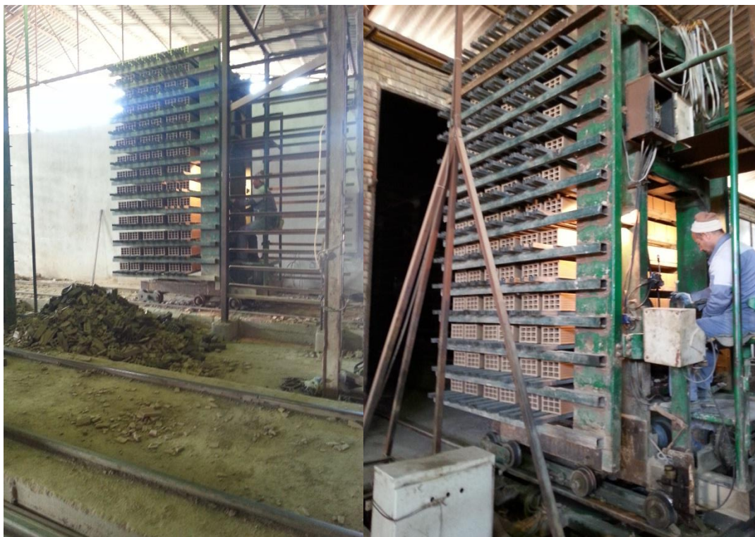
شکل (۳-۱۲) خارج کردن خشت‌های خشک‌شده از اتاق خشک‌کن و حمل به سمت دستگاه الواتور تخلیه
