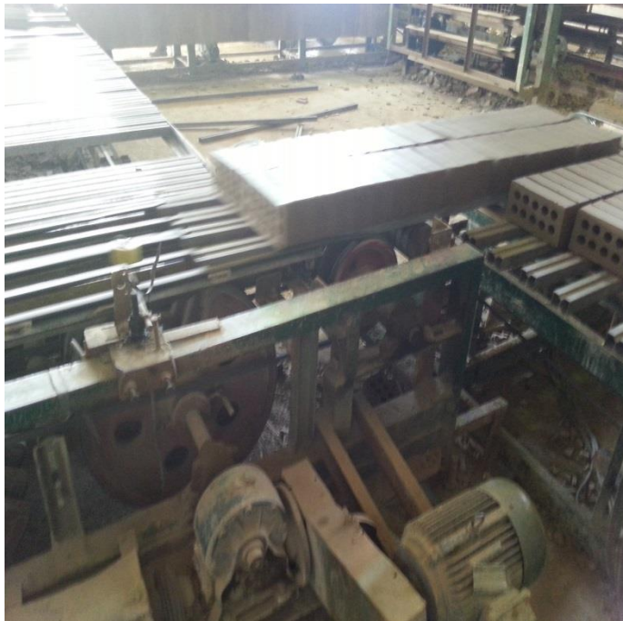
شکل (۳-۸) قرار گرفتن خشت روی پالت آلومینیوم
