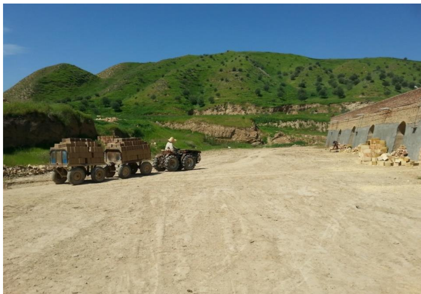
شکل (۳-۱۴) حمل خشت‌های خشک‌شده به کوره جهت خشت‌چینی و پخت
