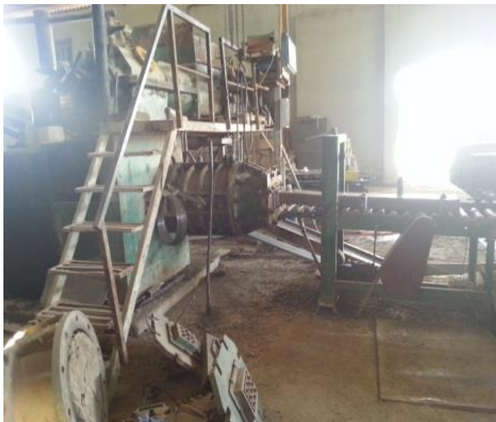
شکل (۳-۶) دستگاه اکسترودر یا پرس در حین تولید شمش
