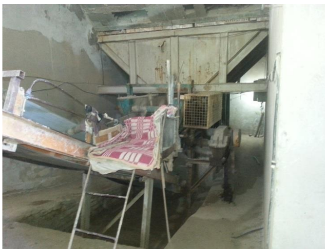
شکل (۲-۳) مخزن خاک، کلوخ شکن و نوار نقاله
