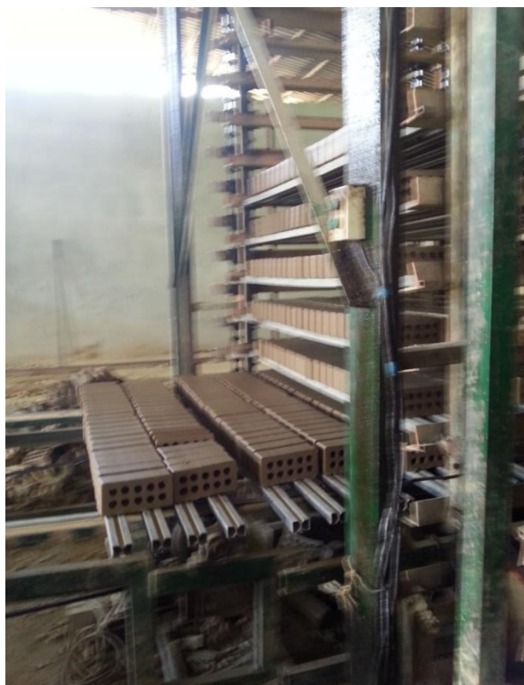
شکل (۳-۹) قرار گرفتن خشت‌های سوار بر پالت در دستگاه الواتور
