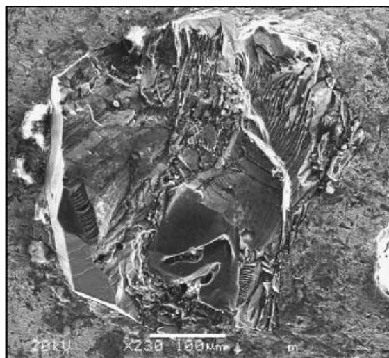
شکل ۲-۲- سطح سائیده شده دانه الماس دیسک برش (Ersoy et al., ۲۰۰۵)
