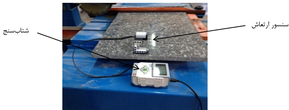
شکل ۷-۵- شتابسنج و سنسور ارتعاش برای ثبت ارتعاشات سیستم
