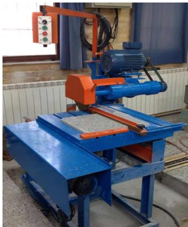
شکل ۵-۶- دستگاه برش سنگ ساخته شده در مقیاس آزمایشگاهی
