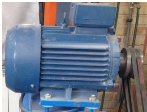
شکل ۵-۴- موتور اصلی دستگاه برش سنگ
