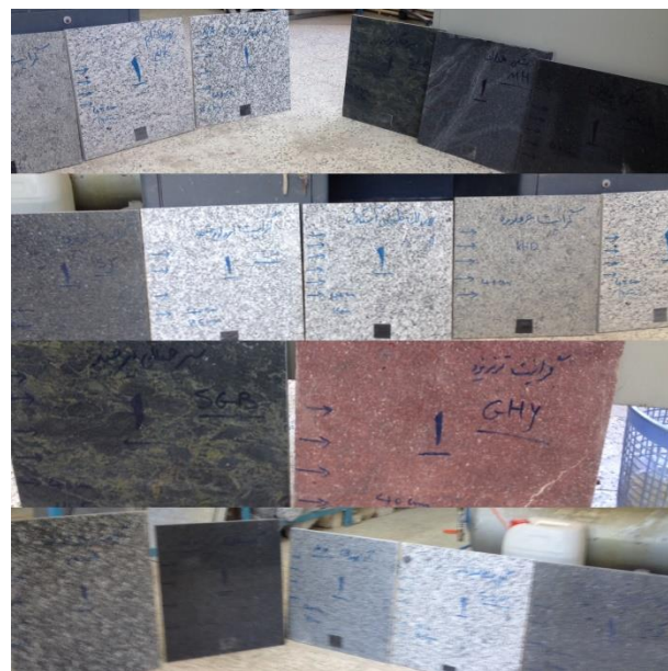
شکل ۵-۲- پلاک های تهیه شده از چهارده نوع سنگ ساختمانی سخت
