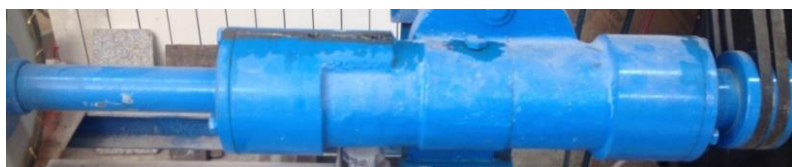
شکل ۳-۵- گلویی دستگاه برش برای بستن دیسک الماس و انتقال نیرو
