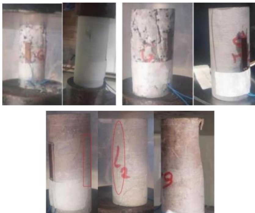
شکل ۴-۱۴: تصاویر نمونه‌های سنگ زیولیت، سنگ آهک، گرانیت و ماسه‌سنگ هنگام بارگذاری (پیش بارگذاری).
