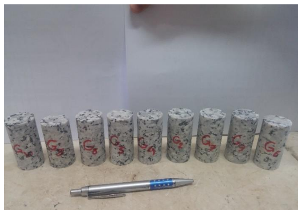
شکل ۳-۴: نمونه‌های مغزه تهیه شده از بلوک سنگ گرانیت جهت آزمایش DRA.
