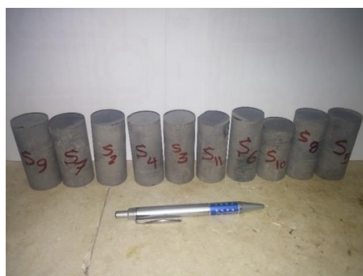
شکل ۵-۴: نمونه‌های مغزه تهیه شده از بلوک سنگ ماسه جهت آزمایش DRA.
