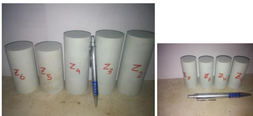
شکل ۴-۷: نمونه‌های مغزه تهیه شده از بلوک سنگ زیولیت جهت آزمایش DRA.
