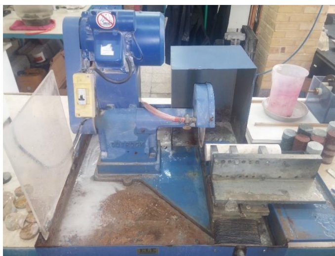
شکل ۴-۲: تصویر دستگاه برش سنگ.
