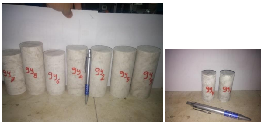
شکل ۴-۶: نمونه‌های مغزه تهیه شده از بلوک سنگ گچ جهت آزمایش DRA.
