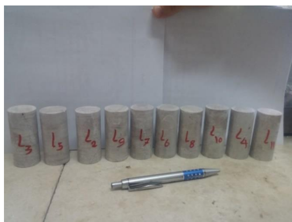
شکل ۴-۴: نمونه‌های مغزه تهیه شده از بلوک سنگ آهک جهت آزمایش DRA.
