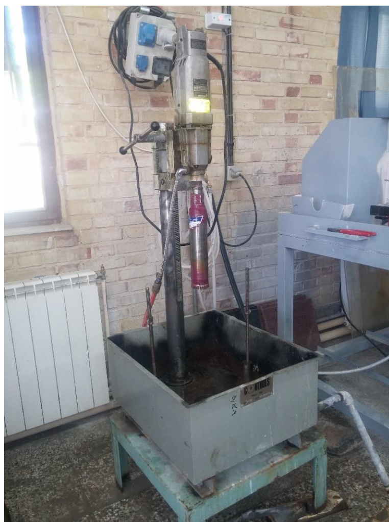
شکل ۴-۱: تصویر دستگاه مغزه گیری مورد استفاده.
