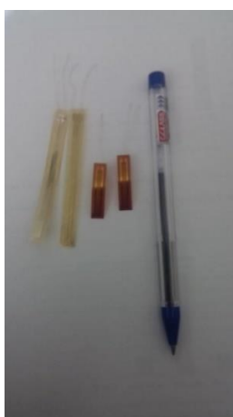
شکل ۴-۸: کرنش‌سنج‌های ۲۰ و ۶۰ میلی‌متری استفاده شده در آزمایش‌ها.
