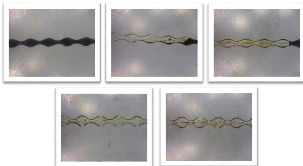
شکل ۴-۱۵ تولید نفت در میکرومدل توسط سورفکتنت
