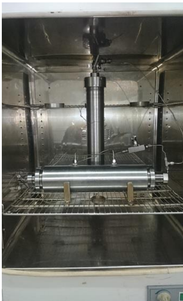
شکل ۲-۱۲ نمایشی از دستگاه سیلابزنی مغزه (آزمایشگاه ازدیاد برداشت دانشگاه شیراز)
