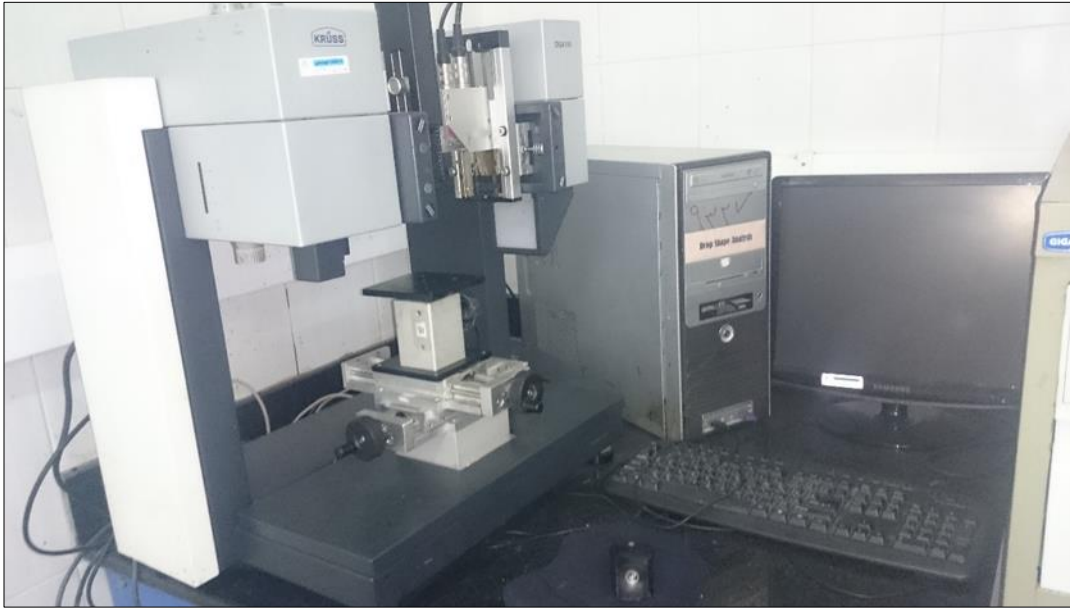
شکل ۱-۲ دستگاه اندازه گیری کشش سطحی و زاویه تماس (آزمایشگاه ازدیاد برداشت دانشگاه شیراز)
