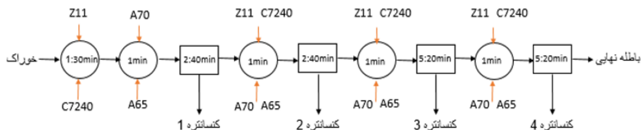
شکل ۳-۳- مراحل انجام آزمایش فلوتاسیون در شرایط عملیاتی کارخانه تغلیظ ۱
